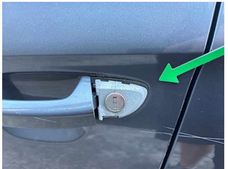
Fahrertür (Anderer Schaden): Teil fehlt
