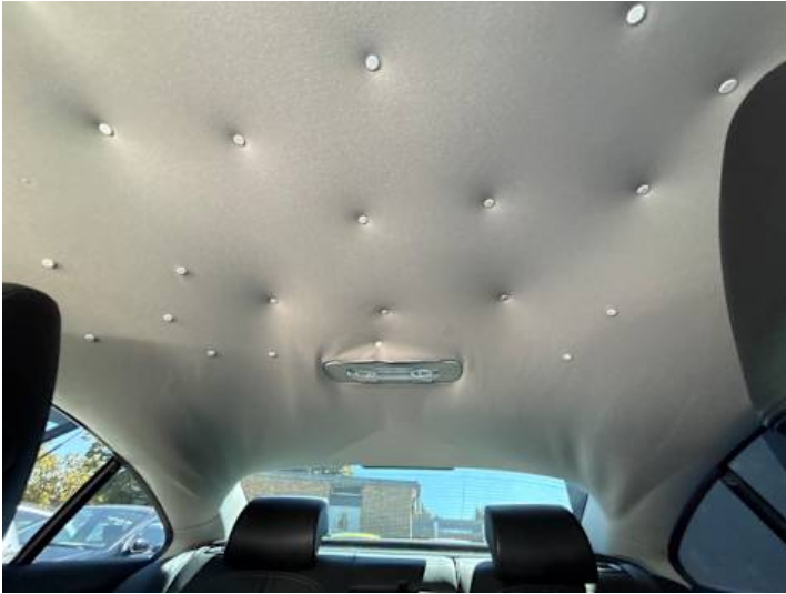
Innenraum (Anderer Schaden): Dachhimmel hängt, wurde provisorisch befestigt;
