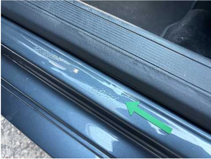
Schweller links (Lackschaden, Unsachgemäß instand gesetzt)
