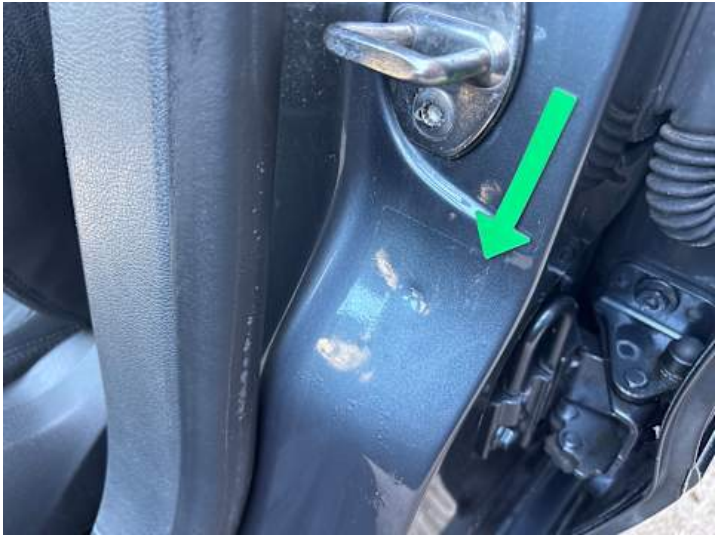
Schweller links (Kratzer, Delle)
