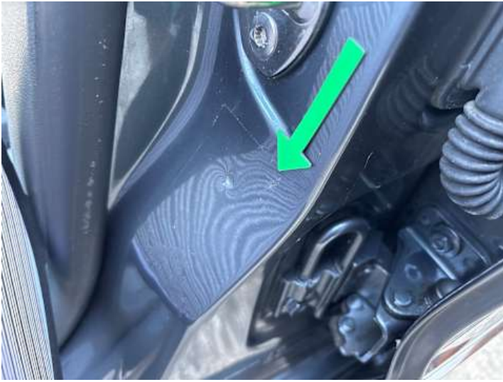
Schweller links (Kratzer, Delle)
