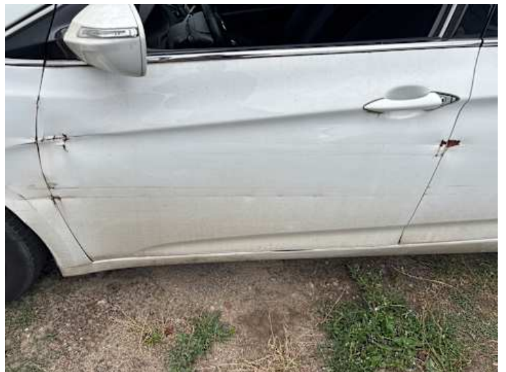
Fahrtür (Delle, Kratzer)
