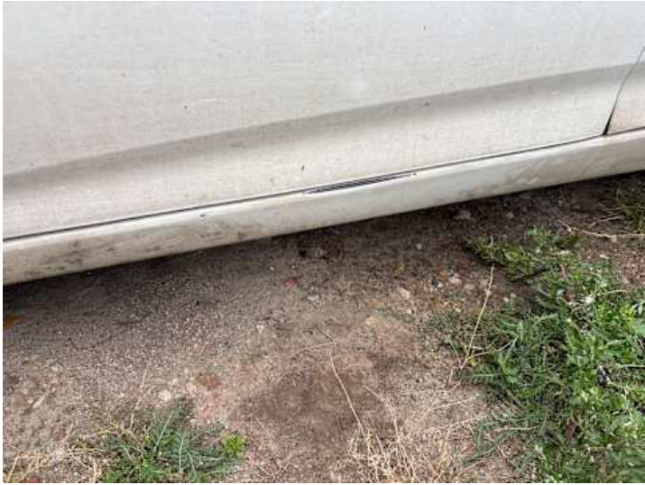
Schweller links (Kratzer)
