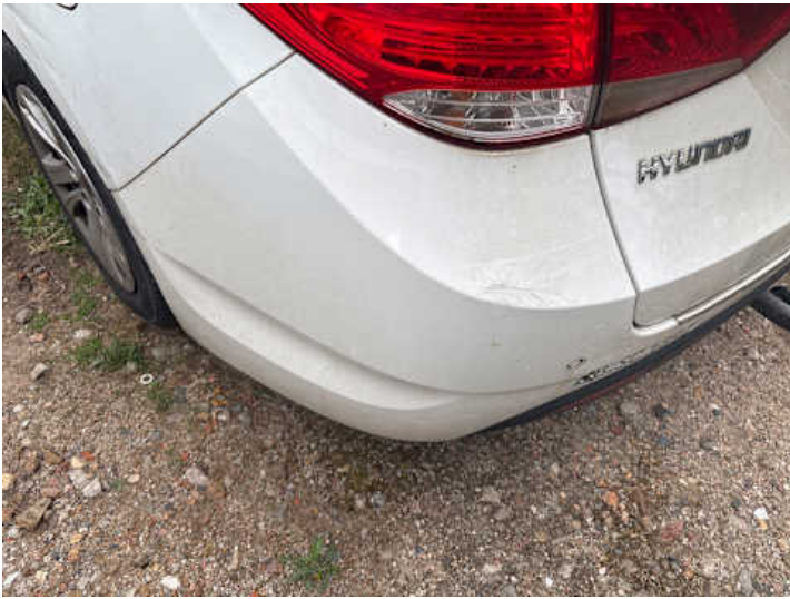
Stoßstange hinten (Kratzer, Verformung)
