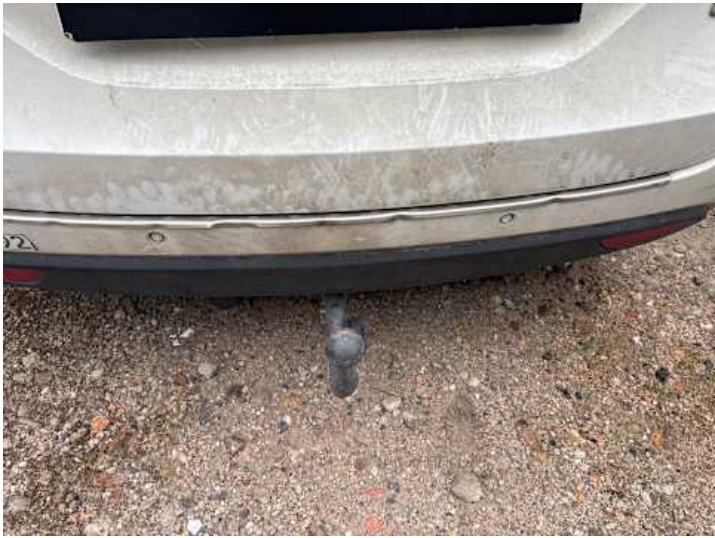
Stoßstange hinten (Kratzer, Verformung)
