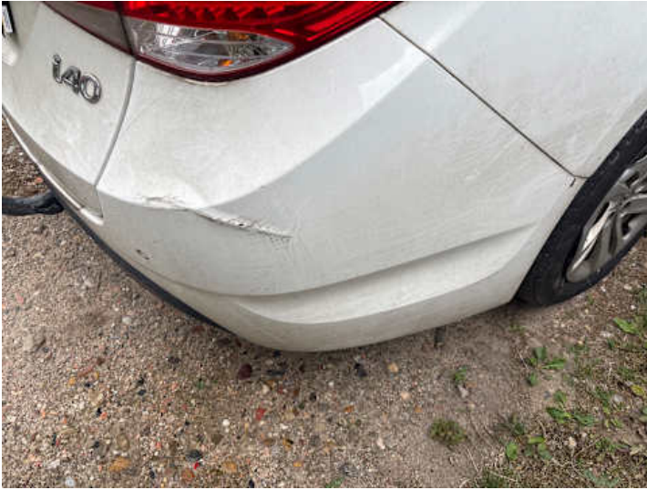
Stoßstange hinten (Kratzer, Verformung)
