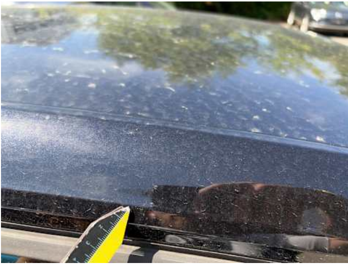
Dach (Lackschaden, Steinschlag, Kratzer)
