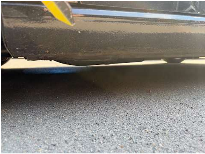
Schweller links (Lackschaden, Kratzer, Verformung)
