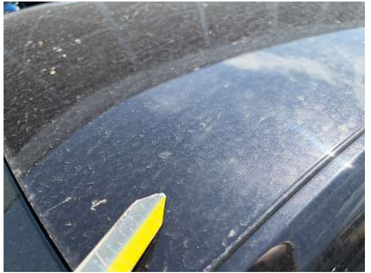
Dach (Lackschaden, Steinschlag, Kratzer)
