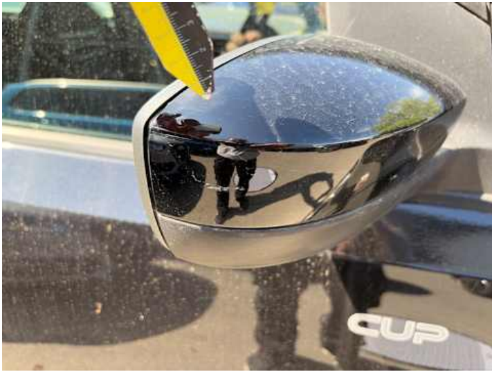
Beifahrertür (Lackschaden, Kratzer)
