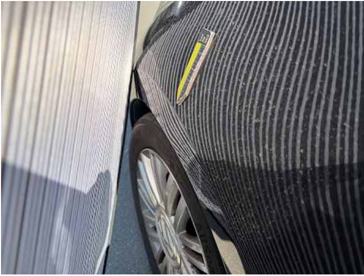
Kotflügel vorne links (Verformung)
