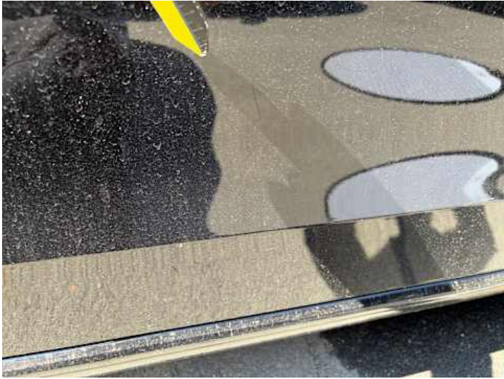
Beifahrer ­ tür (Lackschaden, Kratzer)
