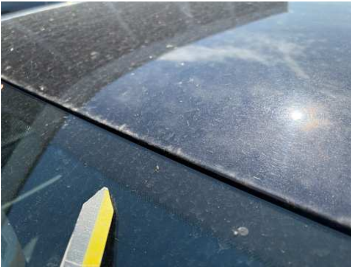
Dach (Lackschaden, Steinschlag, Kratzer)
