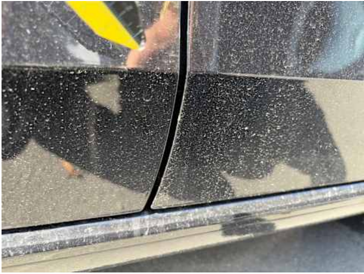
Beifahrer ­ tür (Lackschaden, Kratzer)
