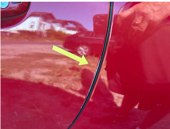
Fahrtür (Delle, Kratzer)
