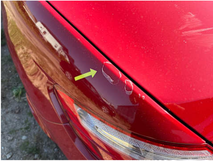
Seitenteil hinten links (Lackschaden)
