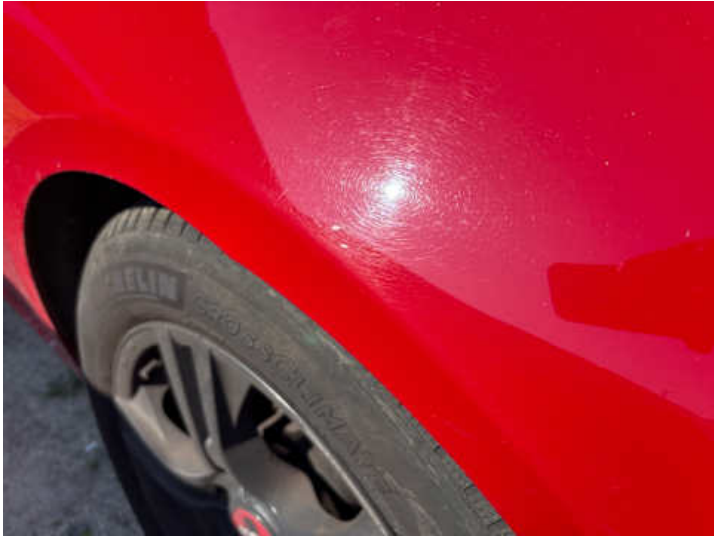
Kotflügel vorne rechts (Kratzer, Verformung)
