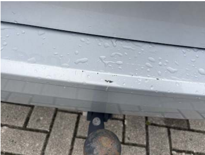
Stoßstange hinten (Lackschaden)
