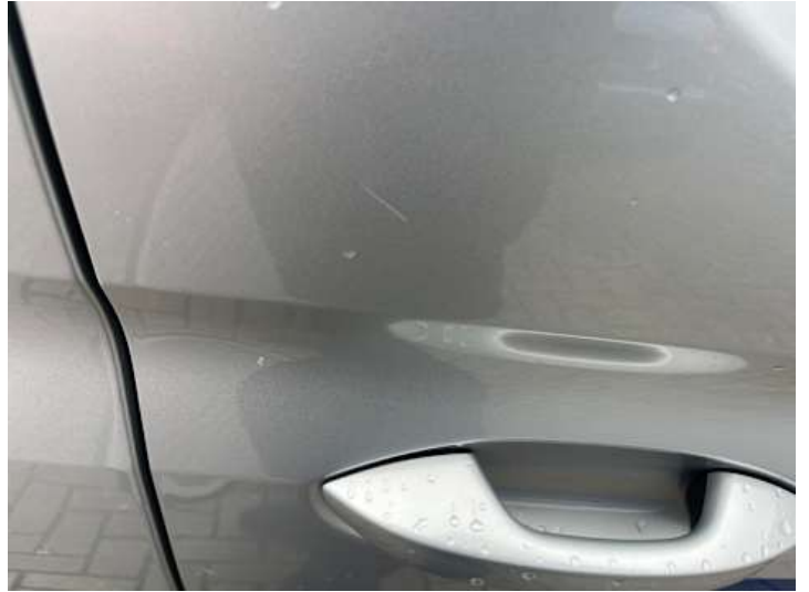
Beifahrertür (Kratzer, Lackschaden)
