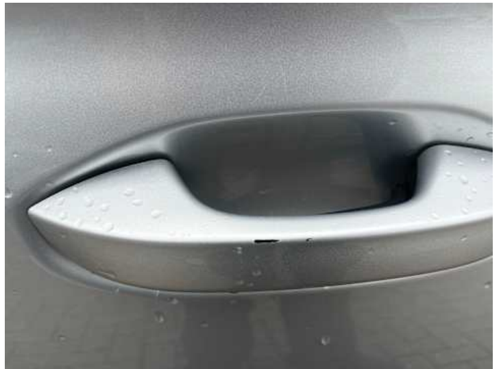
Türe hinten links (Lackschaden)
