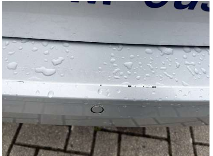
Stoßstange hinten (Lackschaden)
