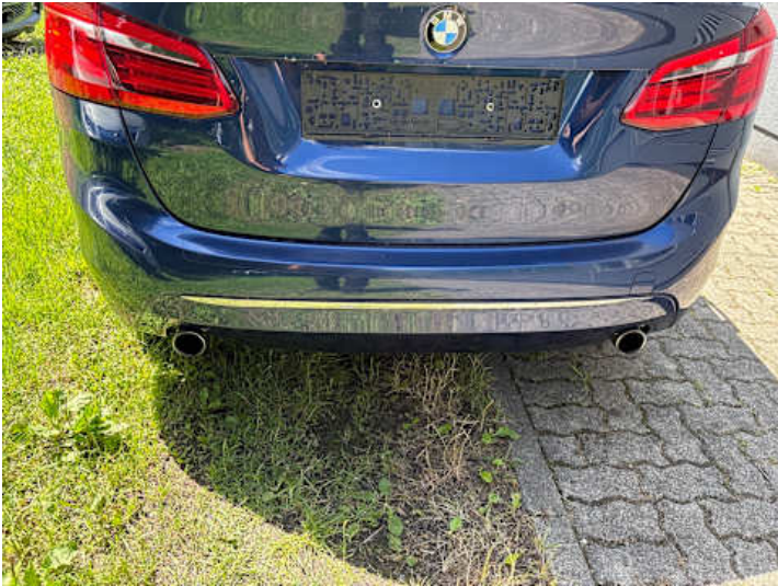
Stoßstange hinten (Lackschaden, Riss/Bruch)
