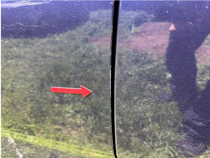
Fahrtür (Lackschaden, Kratzer)
