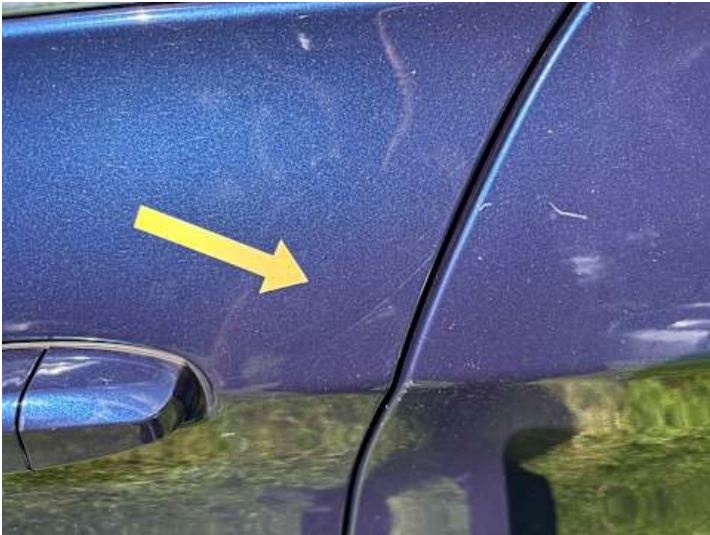
Fahrtür (Lackschaden, Kratzer)
