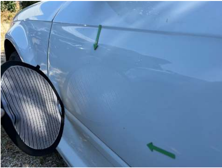
Fahrertür (Delle, Unsachgemäß instand gesetzt)
