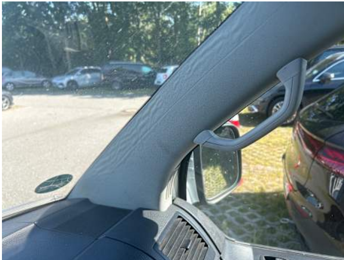
Innenraum (Anderer Schaden, Wassereintritt): Dachhimmel hängt
