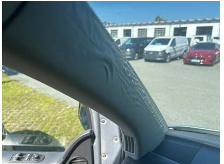
Innenraum (Anderer Schaden, Wassereintritt): Dachhimmel hängt
