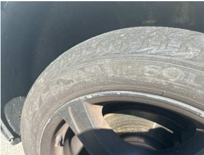
Rad (Kratzer, Kerben, Ungleichmäßig abgefahren)
