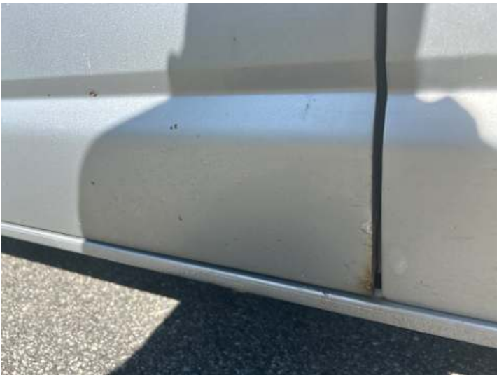
Türe hinten rechts (Kratzer, Rost)
