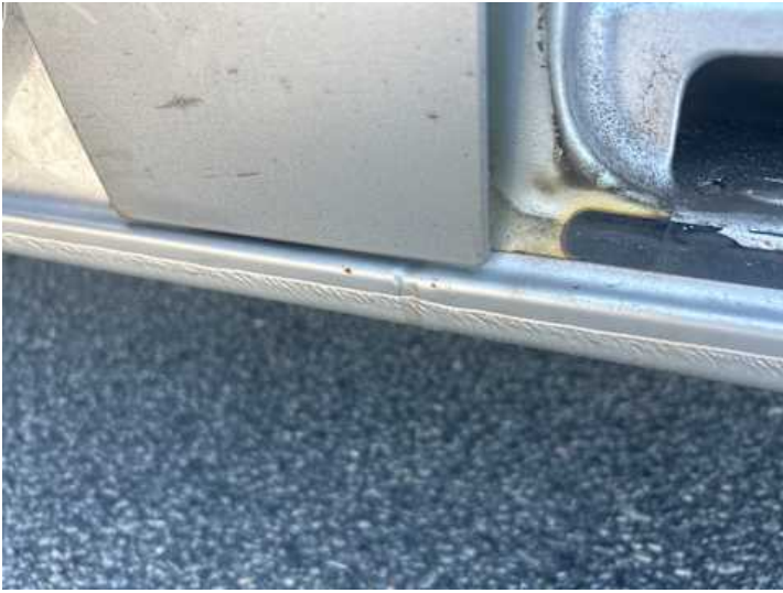
Schweller links (Rost)
