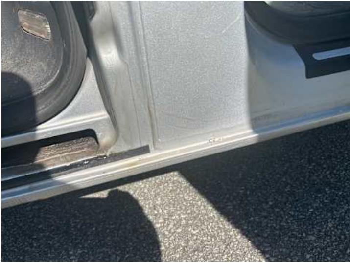
Schweller rechts (Kratzer, Rost)
