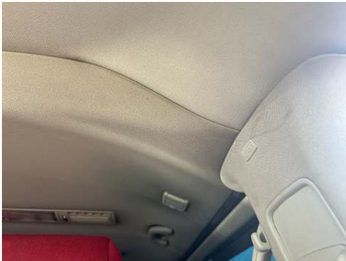
Innenraum (Anderer Schaden, Wassereintritt): Dachhimmel hängt
