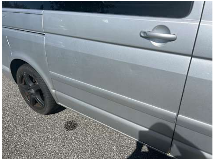
Türe hinten rechts (Kratzer, Rost)
