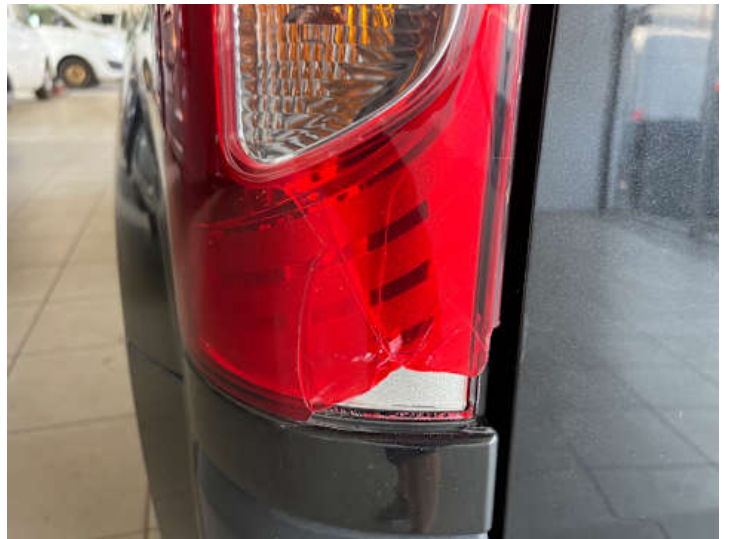
Rücklicht (links) (Riss/Bruch)
