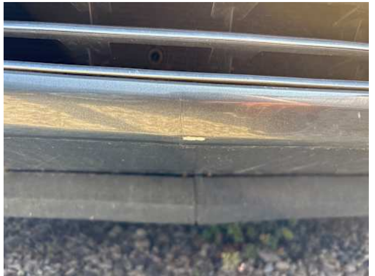
Stoßstange vorne (Kratzer, Verformung)
