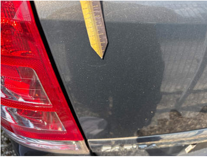
Heckklappe (Delle, Kratzer)
