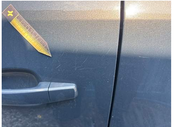
Türe hinten links (Kratzer)
