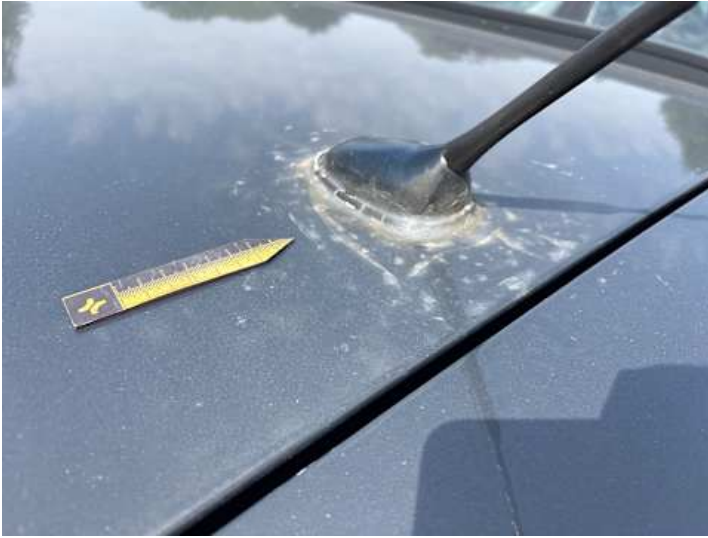
Dach (Anderer Schaden): Antenne verklebt
