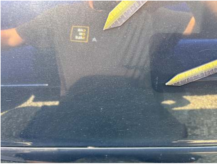
Türe hinten rechts (Kratzer)
