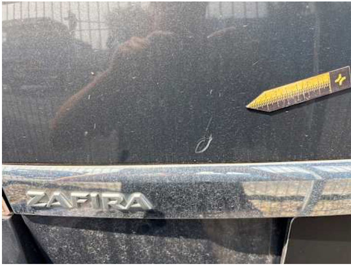
Heckklappe (Delle, Kratzer)
