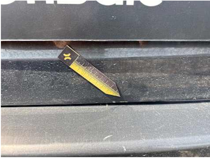
Heckklappe (Delle, Kratzer)
