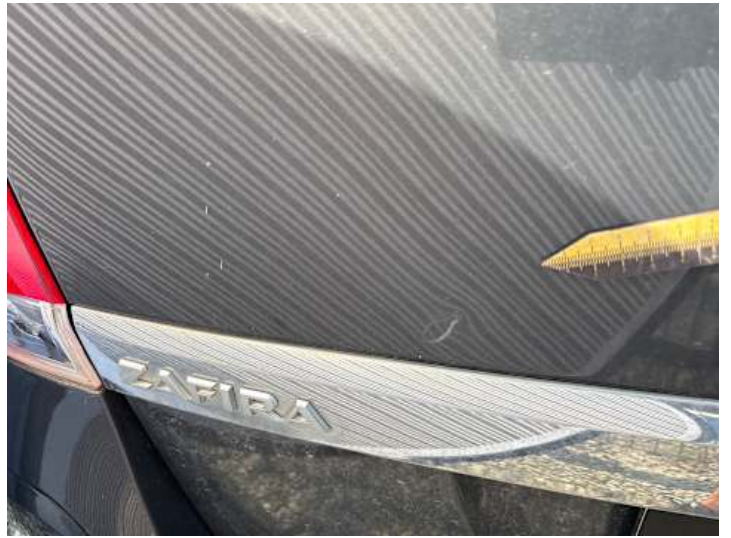
Heckklappe (Delle, Kratzer)
