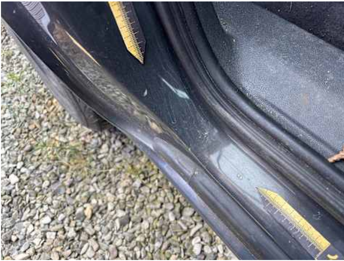
Türe hinten rechts (Kratzer, Delle)
