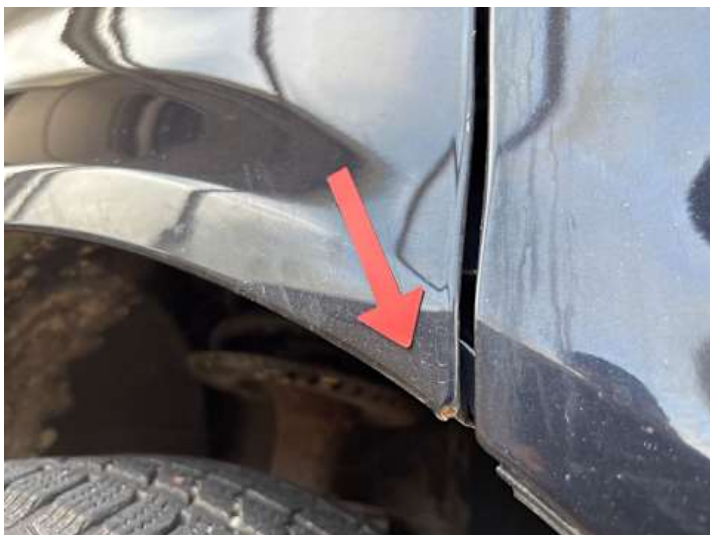
Kotflügel vorne links (Rost)
