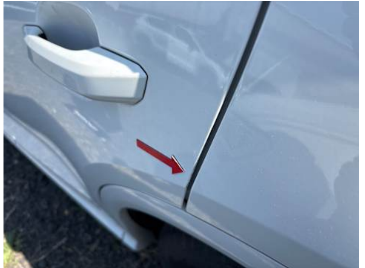
Türe hinten links (Kratzer)
