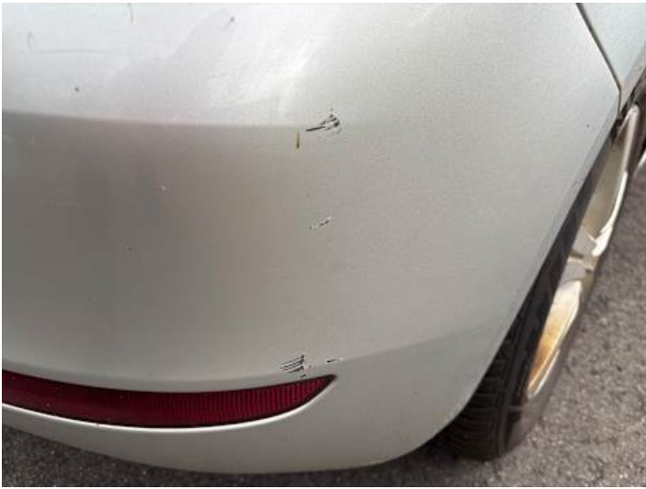
Stoßstange hinten (Kratzer, Lackschaden)
