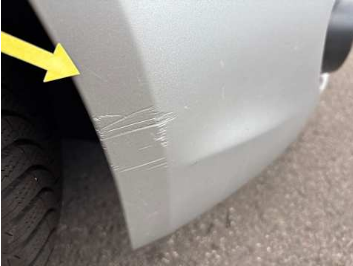
Stoßstange vorne (Kratzer, Lackschaden)
