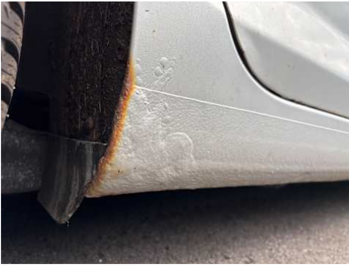
Schweller rechts (Rost)
