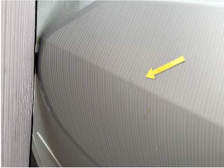
Türe hinten rechts (Delle, Lackschaden)
