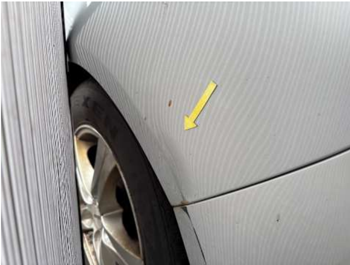
Seitenteil hinten links (Verformung, Rost)
