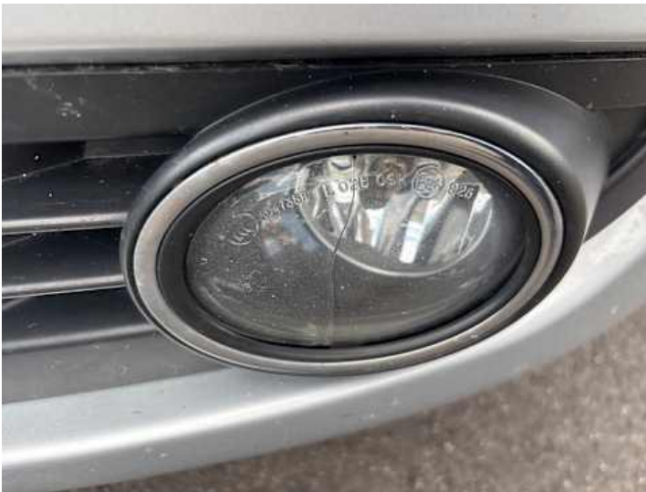
Scheinwerfer (links) (Riss/Bruch)
