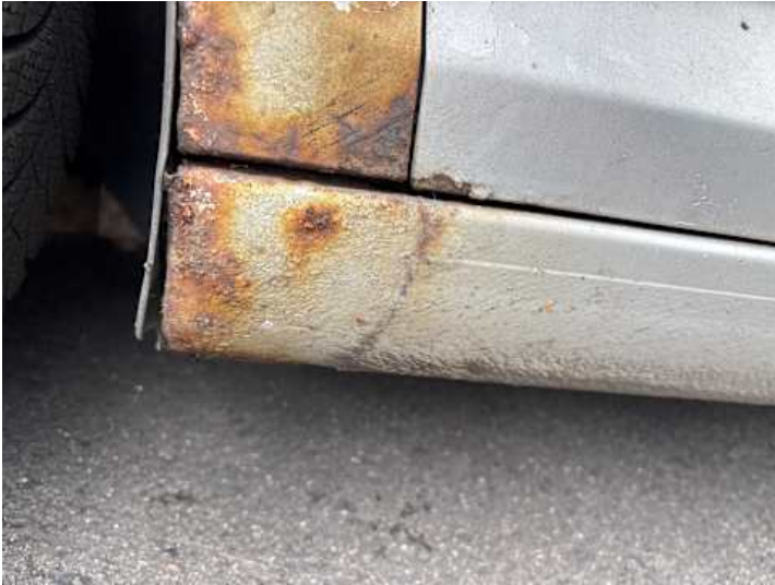
Schweller links (Rost)
