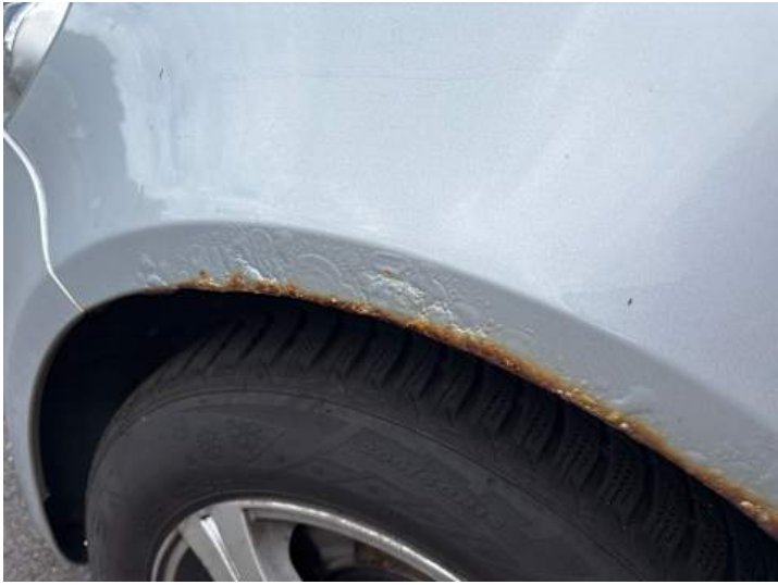
Kotflügel vorne links (Rost)
