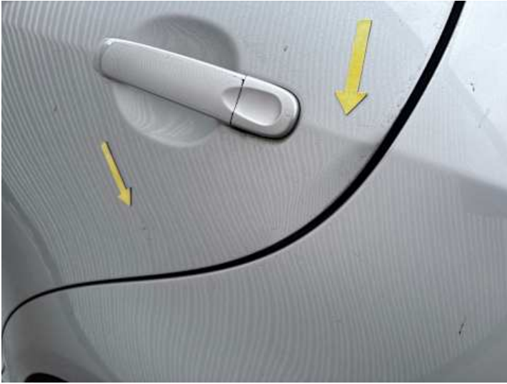
Türe hinten links (Verformung, Delle, Lackschaden)
