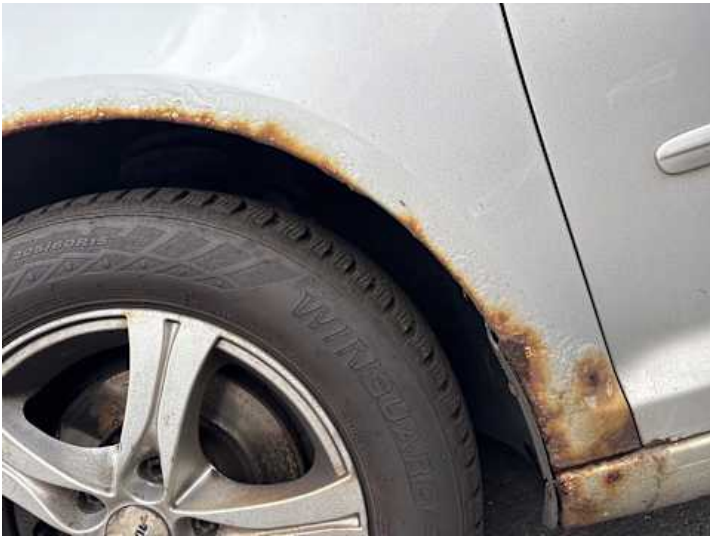
Kotflügel vorne links (Rost)
