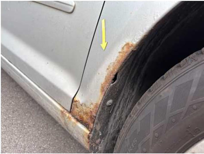
Kotflügel vorne rechts (Rost)
