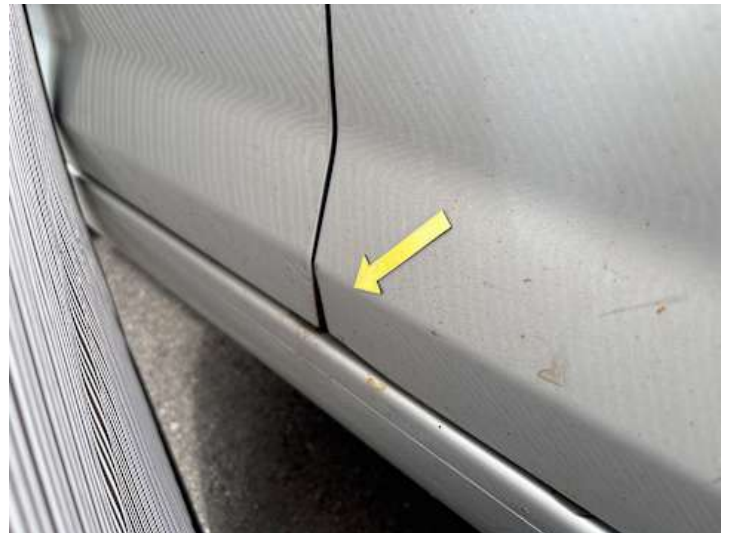
Beifahrtür (Verformung, Rost)
