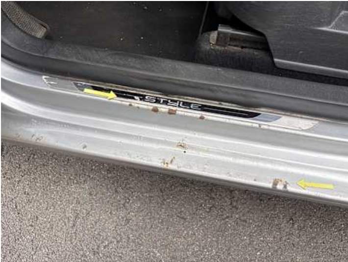
Schweller links (Rost)
