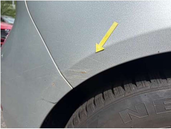
Seitenteil hinten rechts (Kratzer, Rost)
