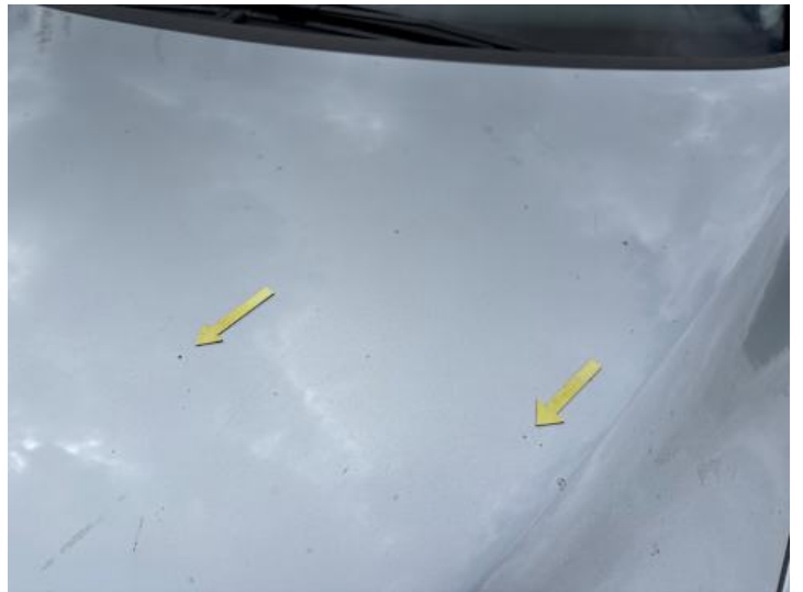
Motorhaube (Steinschlag, Rost)
