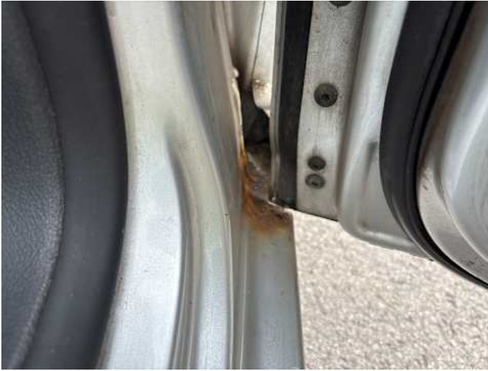
Schweller rechts (Rost)
