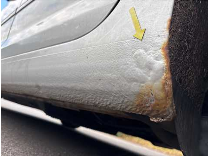
Schweller links (Rost)
