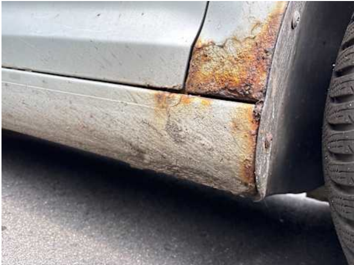
Schweller rechts (Rost)
