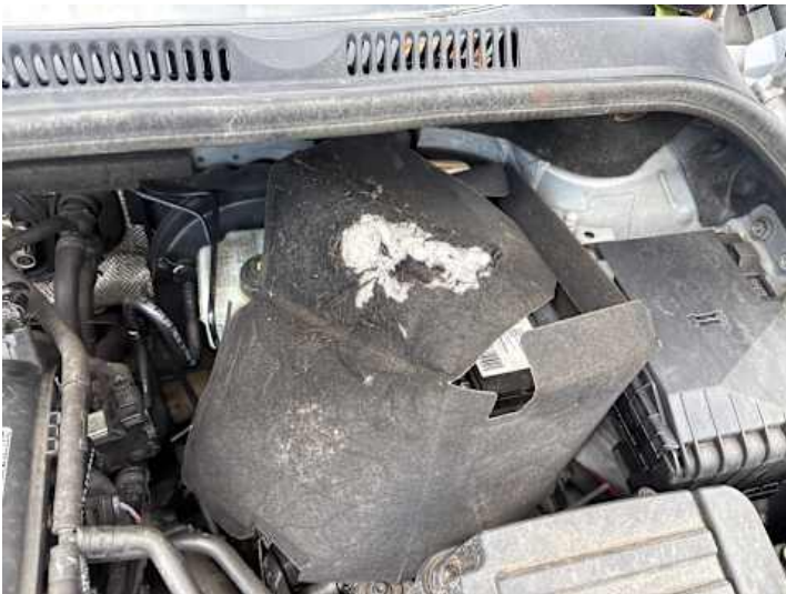
Motorhaube (Anderer Schaden): Vlies Batterie beschädigt
