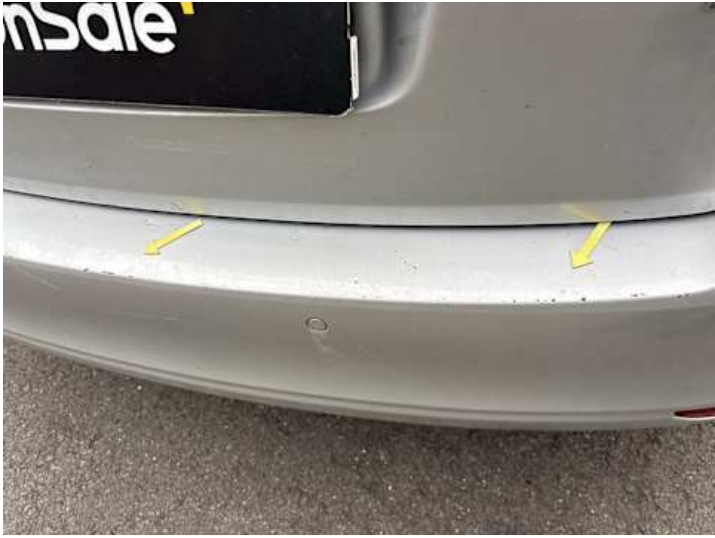
Stoßstange hinten (Lackschaden)
