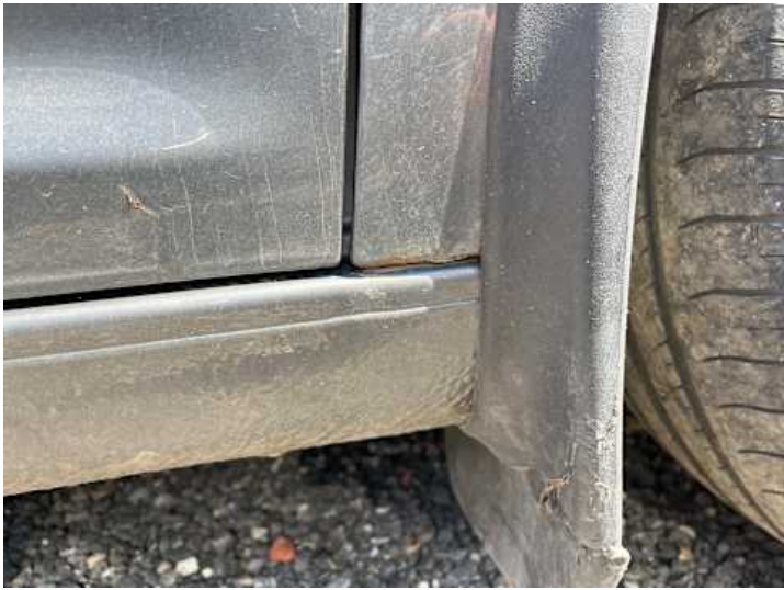
Kotflügel vorne rechts (Rost)
