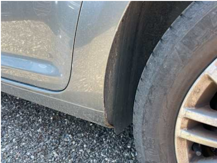
Seitenteil hinten links (Rost)
