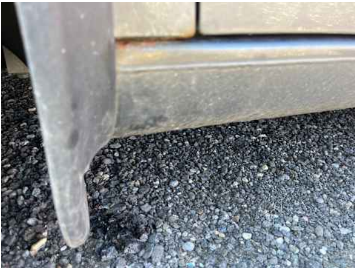
Schweller links (Rost)
