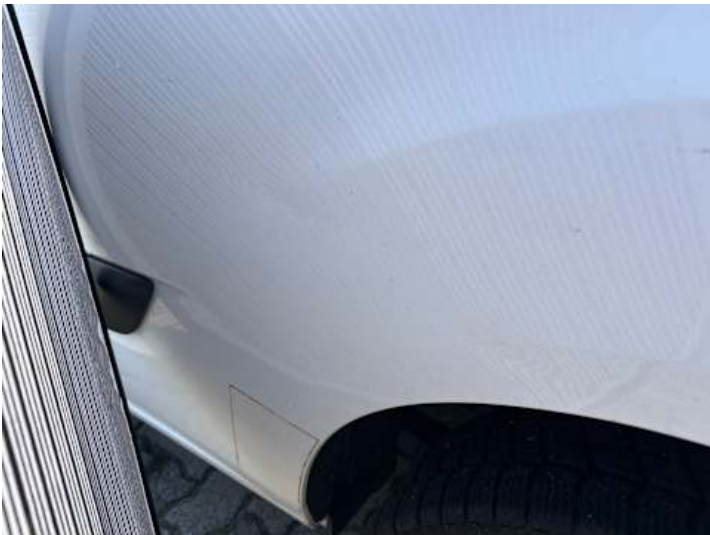
Seitenteil hinten links (Kratzer, Verformung, Delle)
