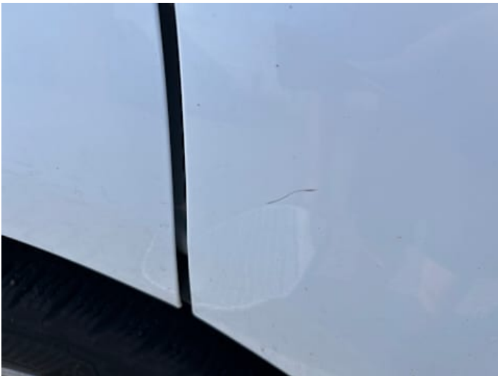
Fahrtür (Kratzer, Anderer Schaden): Flugrost;
