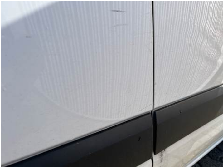
Türe hinten rechts (Delle, Kratzer)
