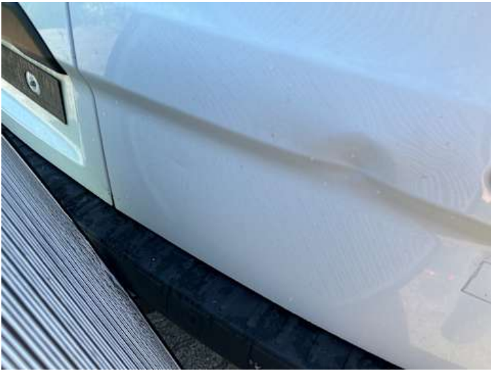
Heckklappe (Kratzer, Delle, Rost)
