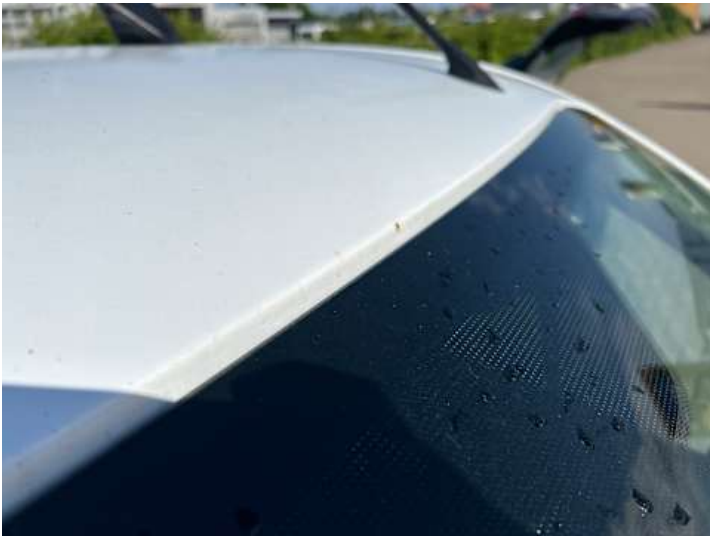
Dach (Delle, Steinschlag)
