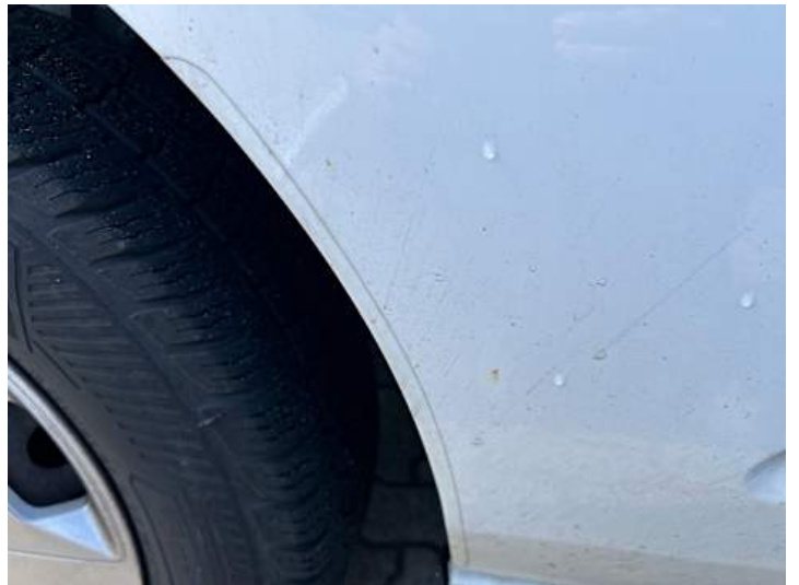
Fahrtür (Kratzer, Anderer Schaden): Flugrost;
