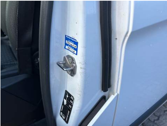
Fahrertür (Kratzer, Anderer Schaden): Flugrost;
