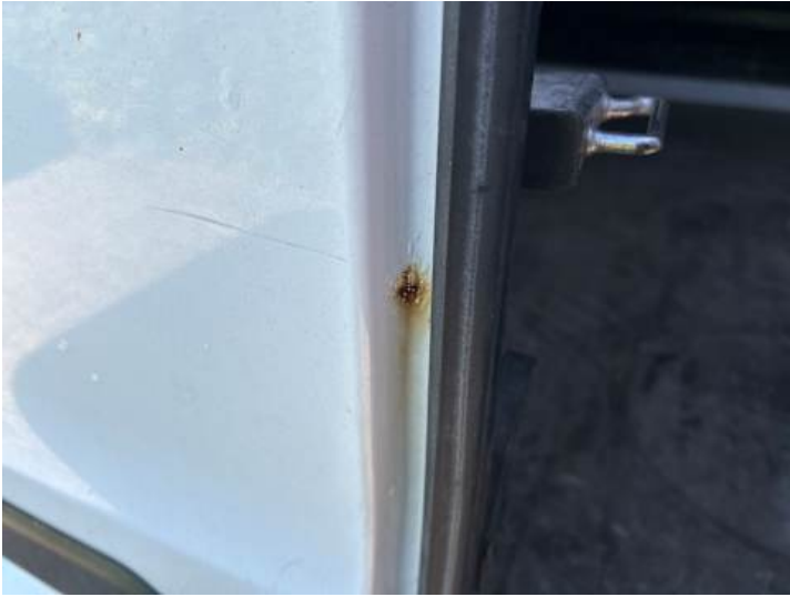
Heckklappe (Kratzer, Delle, Rost)
