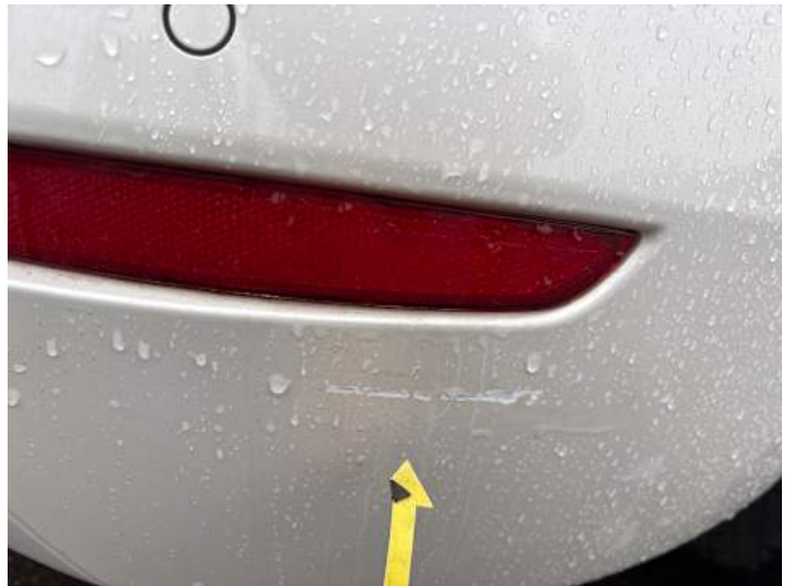
Stoßstange hinten (Kratzer, Unsachgemäß instand gesetzt)
