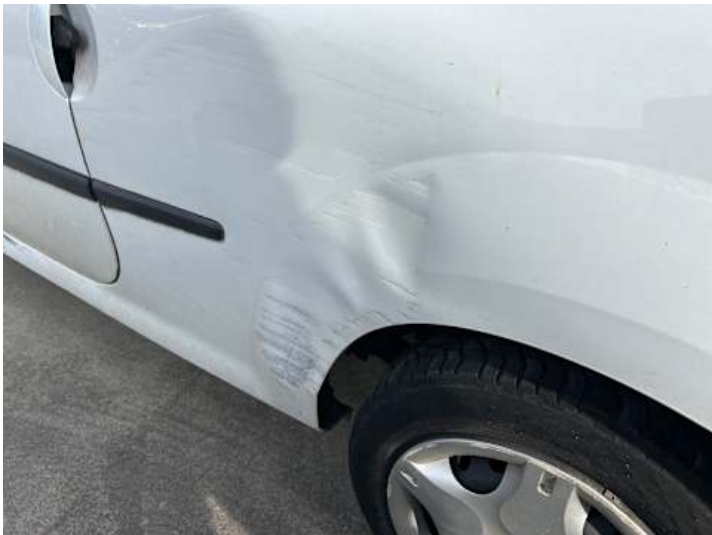
Seitenteil hinten links (Verformung, Kratzer)
