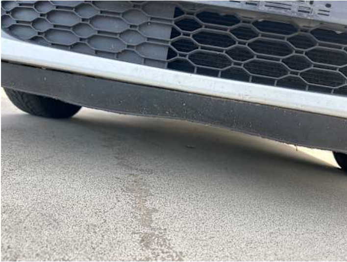
Stoßstange vorne (Verformung)
