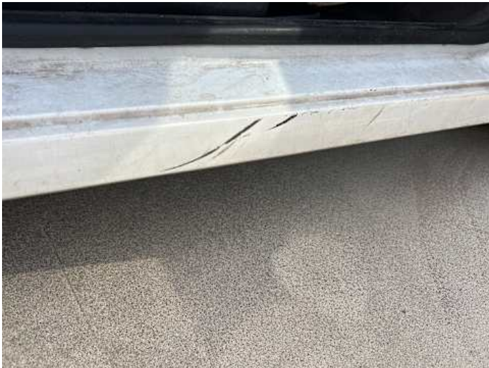
Schweller rechts (Kratzer)
