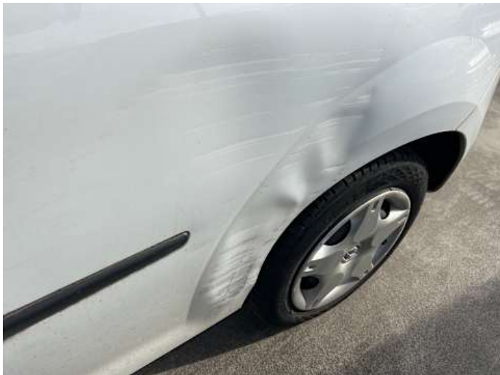
Seitenteil hinten links (Verformung, Kratzer)
