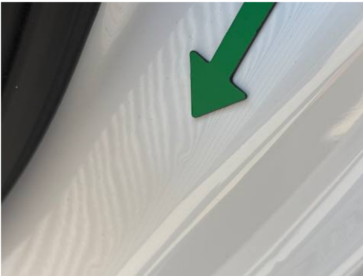
Schweller links (Delle)
