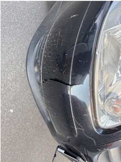
Stoßstange vorne (Riss/Bruch)
