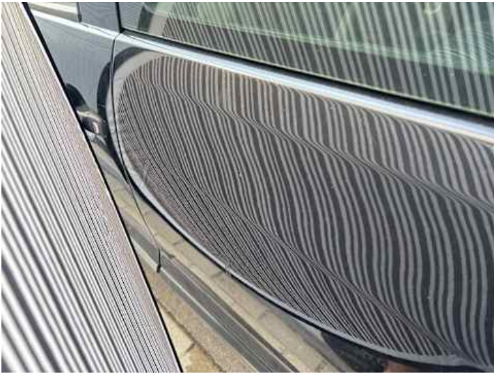
Seitenteil hinten links (Delle)
