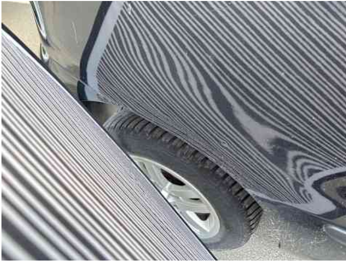
Seitenteil hinten rechts (Delle)
