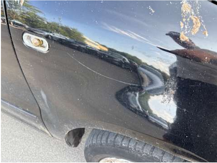
Kotflügel vorne rechts (Kratzer)
