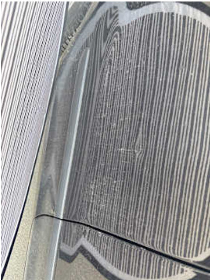
Seitenteil hinten rechts (Delle)
