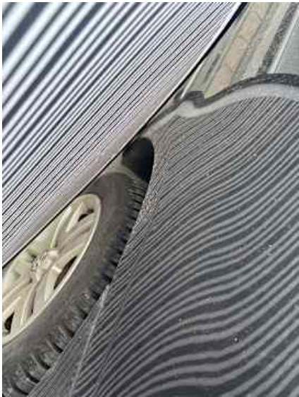
Seitenteil hinten links (Delle)
