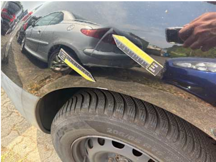
Kotflügel vorne links (Delle, Kratzer, Rost)
