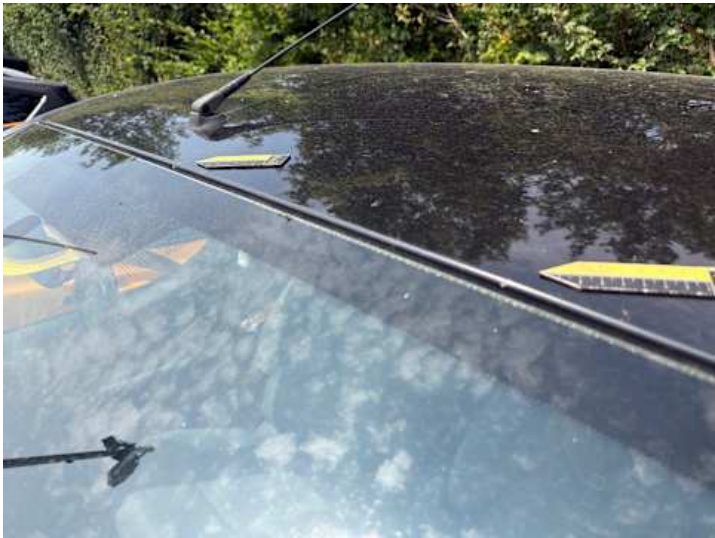
Dach (Steinschlag, Rost)
