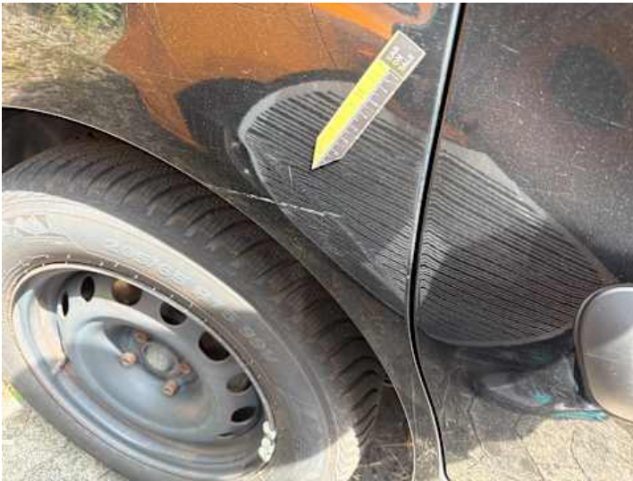
Seitenteil hinten rechts (Kratzer)
