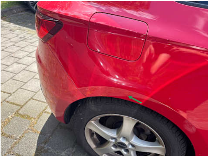
Seitenteil hinten rechts (Lackschaden, Unsachgemäß instand gesetzt)
