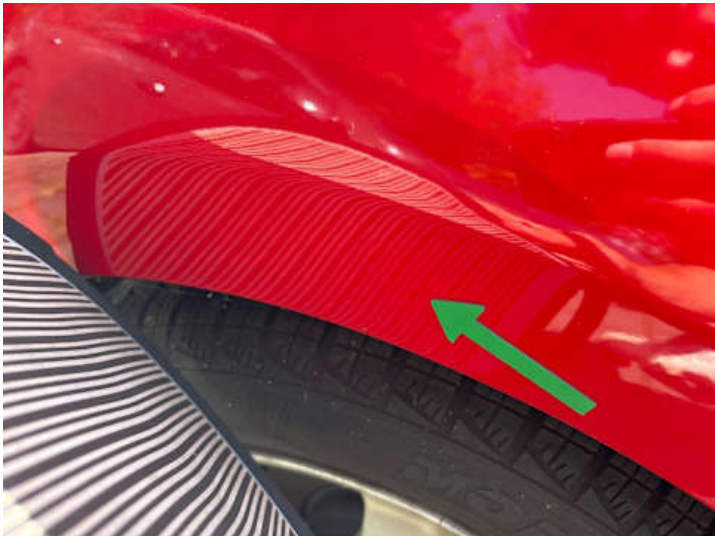
Seitenteil hinten rechts (Lackschaden, Unsachgemäß instand gesetzt)
