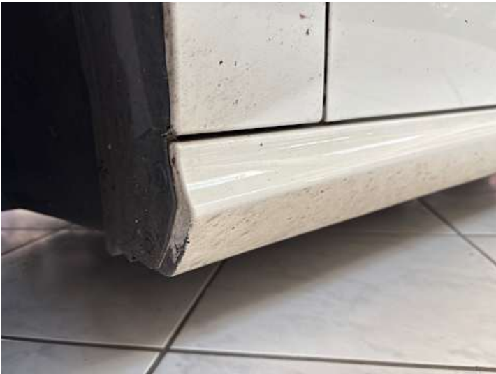
Schweller links (Lackschaden)
