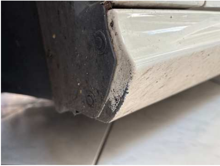
Schweller links (Lackschaden)
