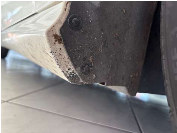
Schweller rechts (Lackschaden)
