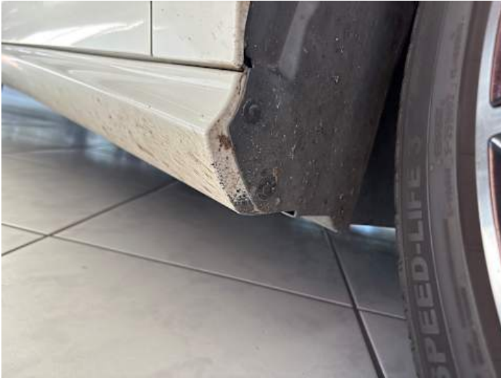
Schweller rechts (Lackschaden)
