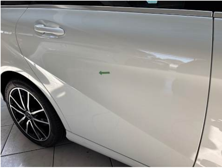
Türe hinten rechts (Delle, Kratzer)
