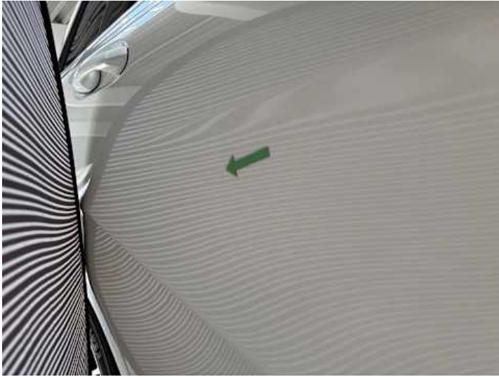
Türe hinten rechts (Delle, Kratzer)
