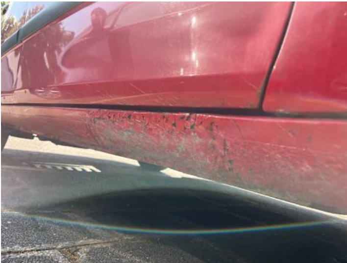
Schweller rechts (Rost)
