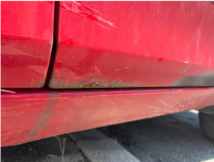
Türe hinten links (Rost)
