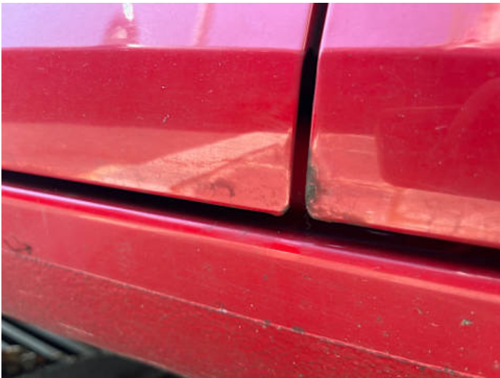
Türe hinten rechts (Rost)
