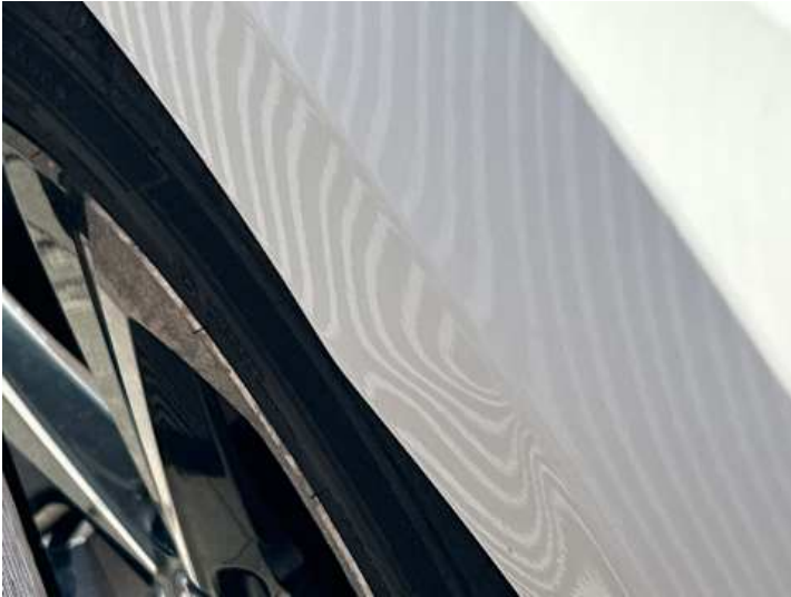
Kotflügel vorne rechts (Verformung)
