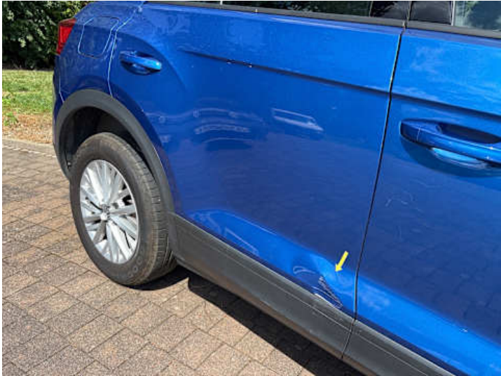
Türe hinten rechts (Lackschaden, Verformung)
