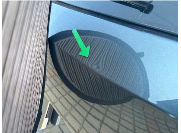
Heckklappe (Delle, Verformung)
