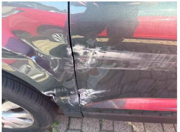
Fahrtür (Kratzer, Lackschaden, Verformung, Riss/Bruch, Spaltmaße ungenau)
