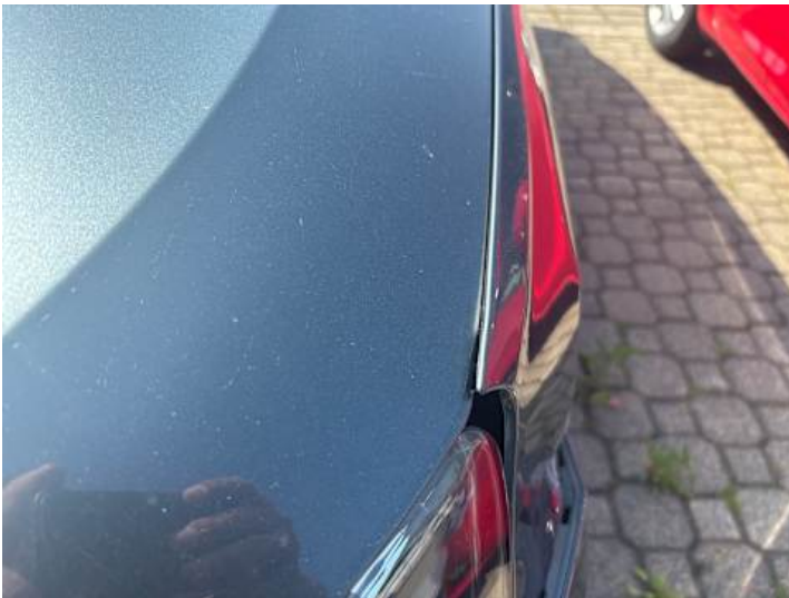
Motorhaube (Spaltmaße ungenau, Kratzer, Lackschaden)
