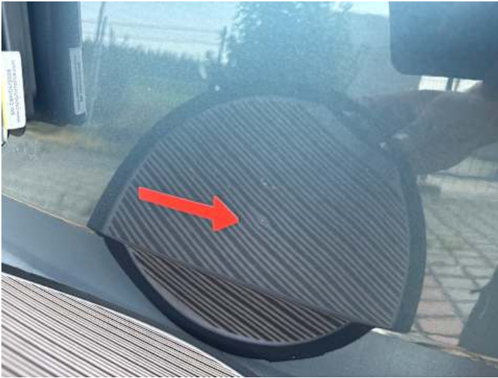
Heckklappe (Delle, Verformung)
