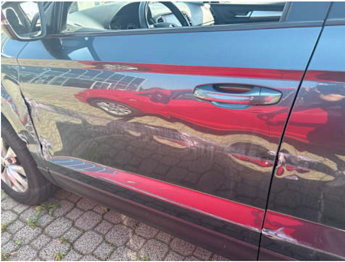
Fahrtür (Kratzer, Lackschaden, Verformung, Riss/Bruch, Spaltmaße ungenau)
