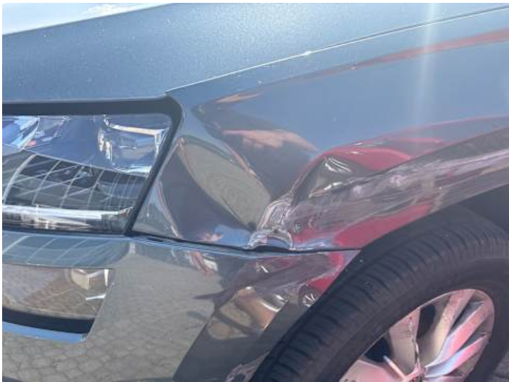
Kotflügel vorne links (Kratzer, Lackschaden, Spaltmaße ungenau, Verformung)
