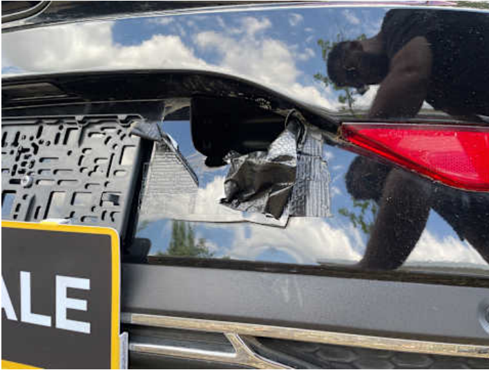
Stoßstange hinten (Riss/Bruch)
