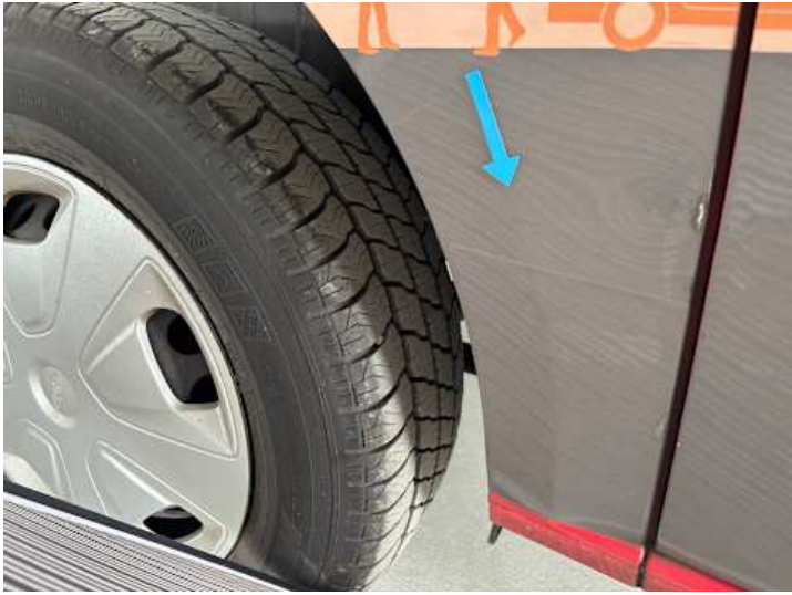
Seitenteil hinten rechts (Verformung)
