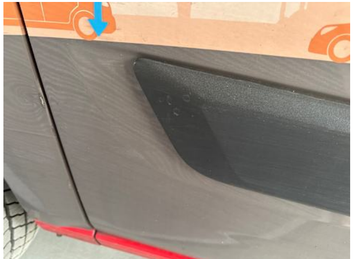
Türe hinten rechts (Verformung)
