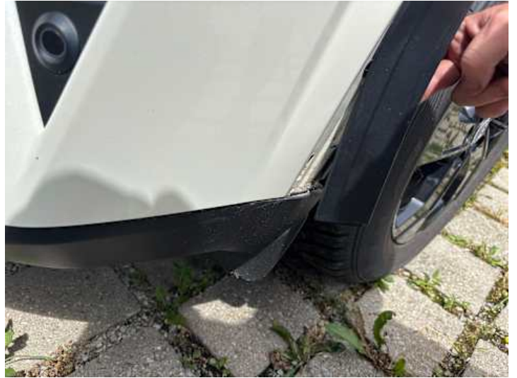
Kotflügel vorne links (Riss/Bruch)
