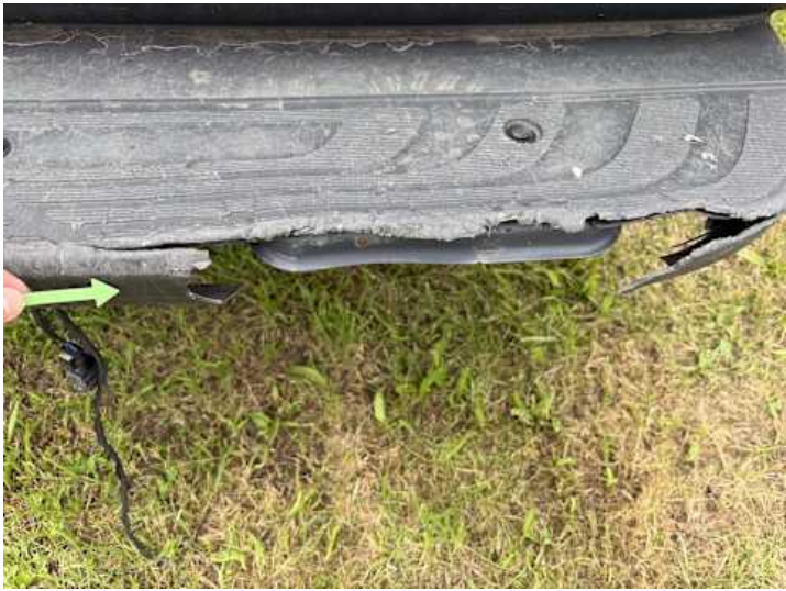
Stoßstange hinten (Verformung, Riss/Bruch)
