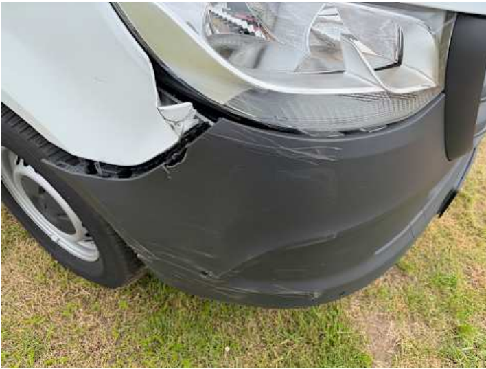
Stoßstange vorne (Kratzer, Verformung, Riss/Bruch)
