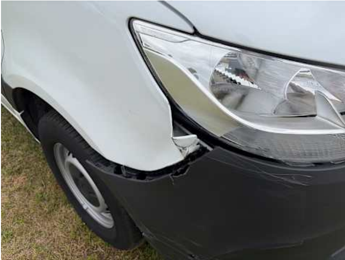
Kotflügel vorne rechts (Verformung, Kratzer)
