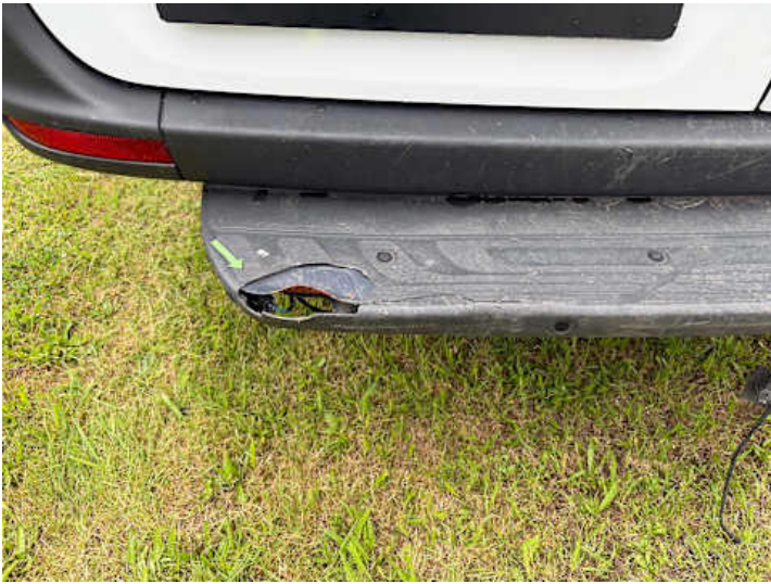
Stoßstange hinten (Verformung, Riss/Bruch)
