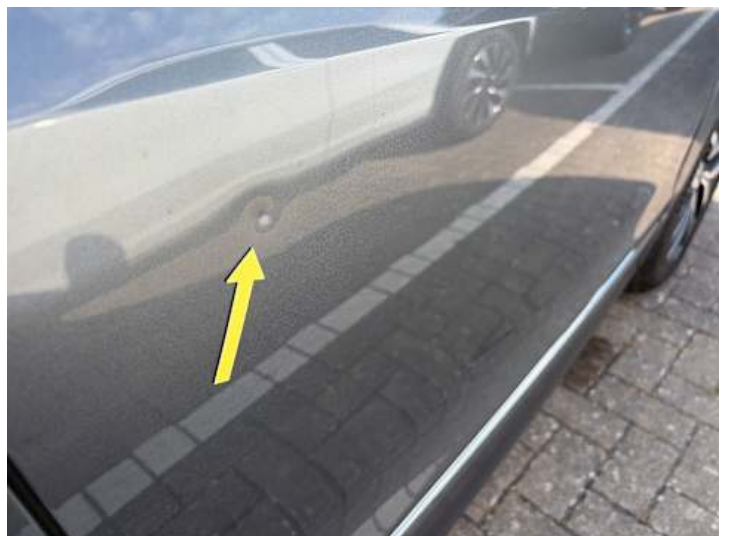
Beifahrtür (Lackschaden, Delle)
