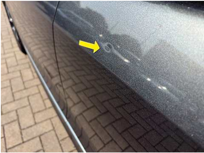
Türe hinten links (Kratzer, Delle)
