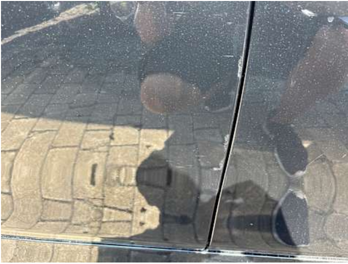
Türe hinten rechts (Kratzer, Unsachgemäß instand gesetzt)
