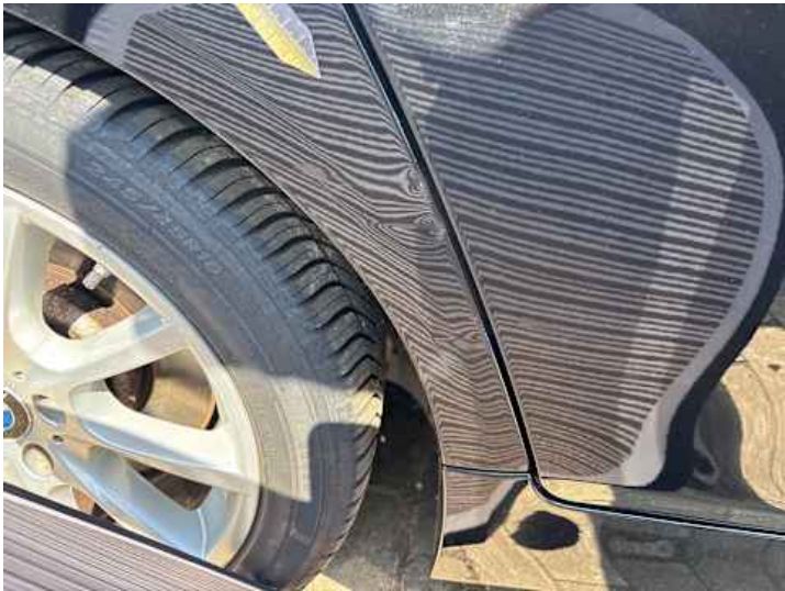
Seitenteil hinten rechts (Kratzer, Verformung, Delle)
