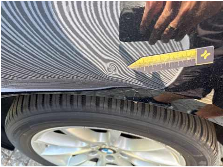
Seitenteil hinten links (Kratzer, Delle)
