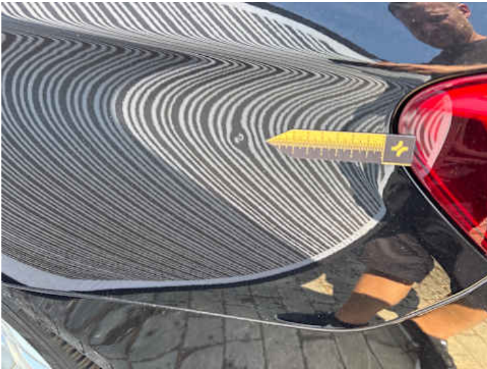
Seitenteil hinten links (Kratzer, Delle)
