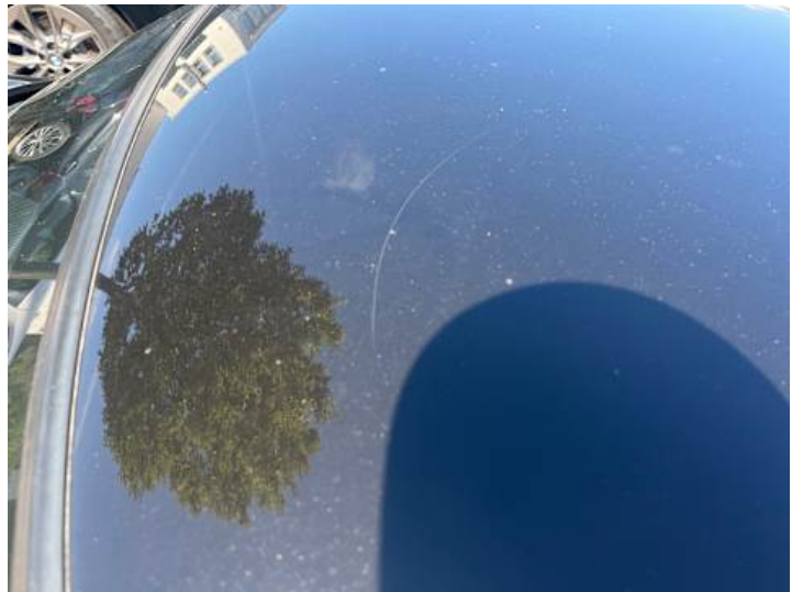
Dach (Kratzer, Lackschaden)
