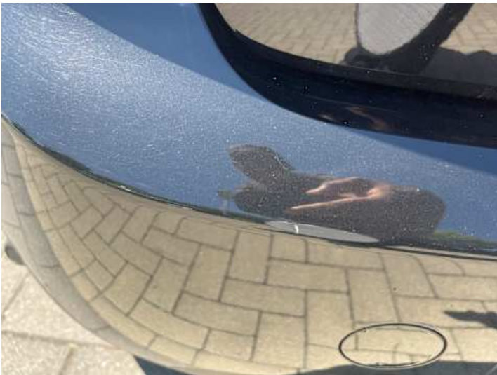
Stoßstange hinten (Lackschaden)
