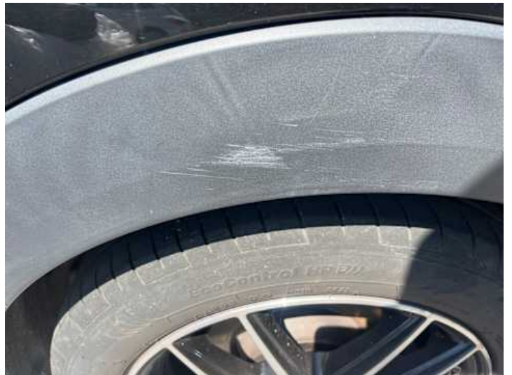
Seitenteil hinten links (Kratzer, Lackschaden)
