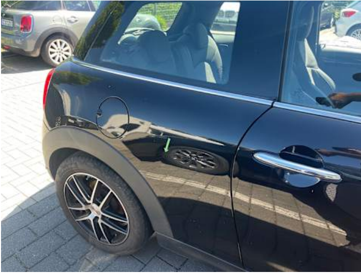
Seitenteil hinten rechts (Delle)
