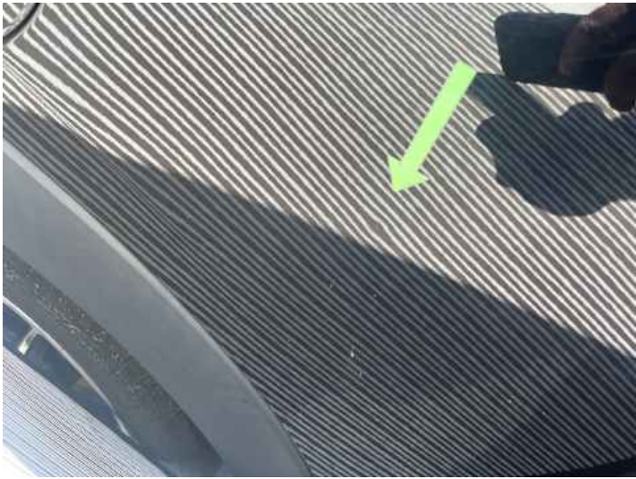
Seitenteil hinten rechts (Delle)
