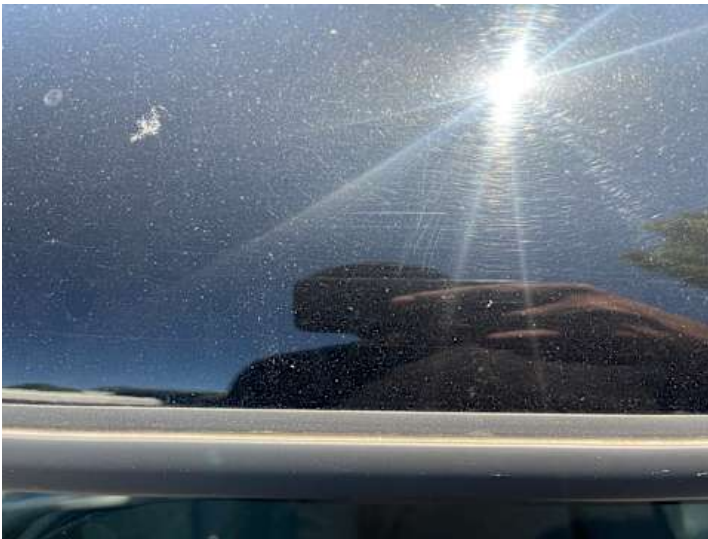
Dach (Kratzer, Lackschaden)
