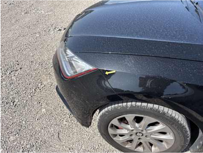
Stoßstange vorne (Spaltmaße ungenau)
