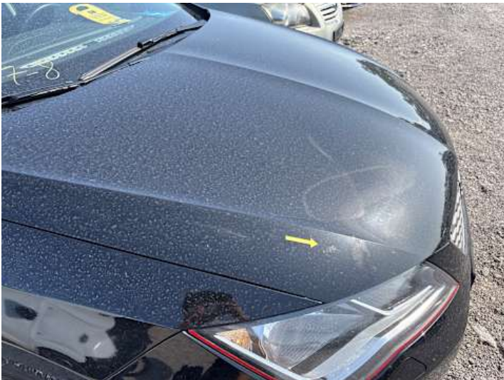
Motorhaube (Kratzer, Unsachgemäß instand gesetzt)
