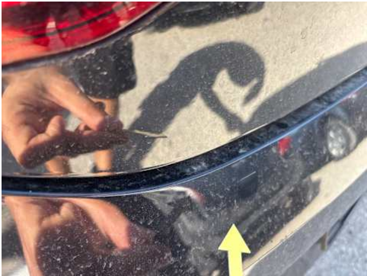
Stoßstange hinten (Kratzer)
