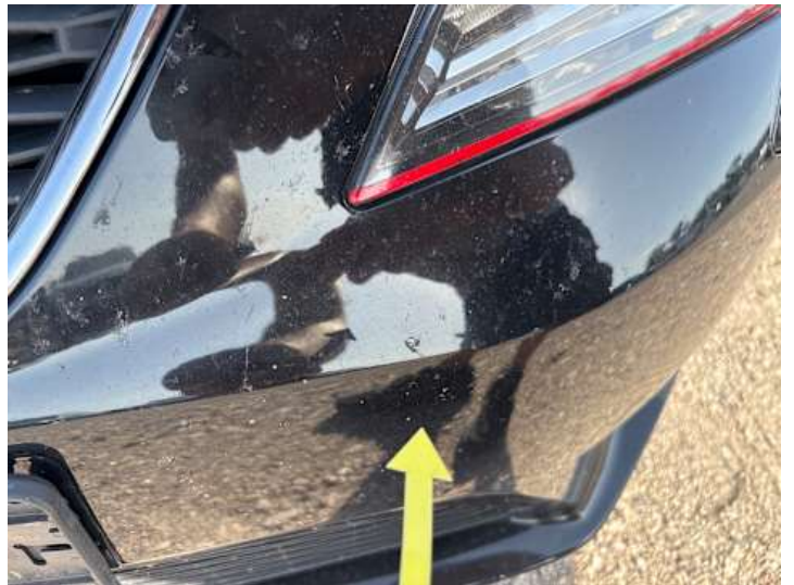
Stoßstange vorne (Steinschlag)
