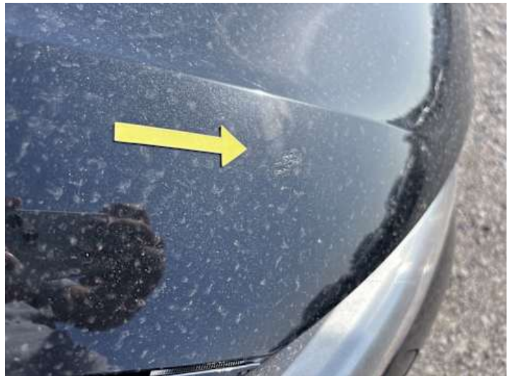
Motorhaube (Kratzer, Unsachgemäß instand gesetzt)
