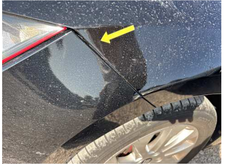
Stoßstange vorne (Spaltmaße ungenau)
