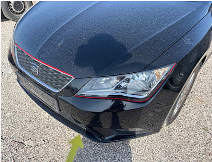
Stoßstange vorne (Steinschlag)
