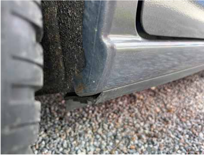
Schweller rechts (Rost)
