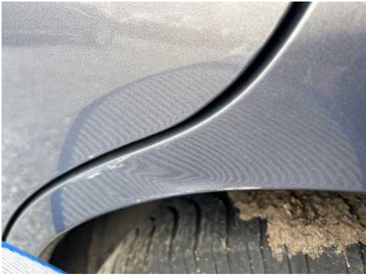
Seitenteil hinten links (Lackschaden, Kratzer, Verformung)
