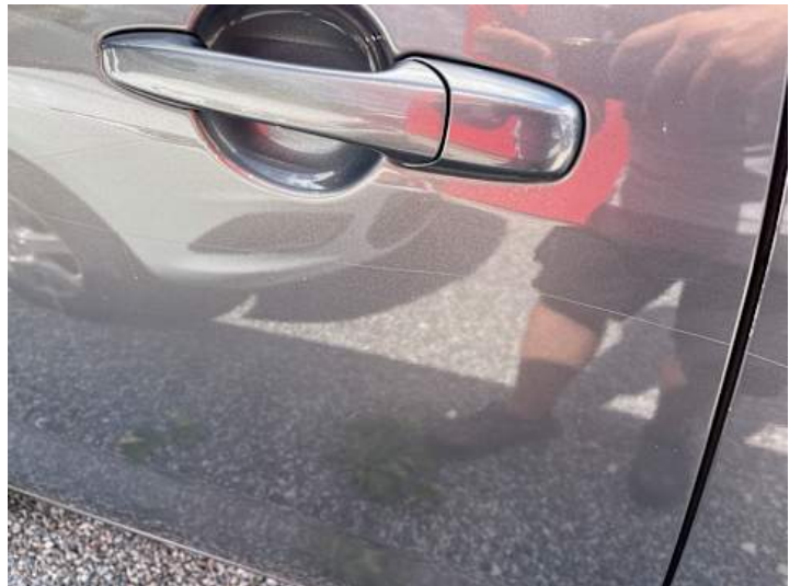
Türe hinten rechts (Lackschaden, Kratzer)
