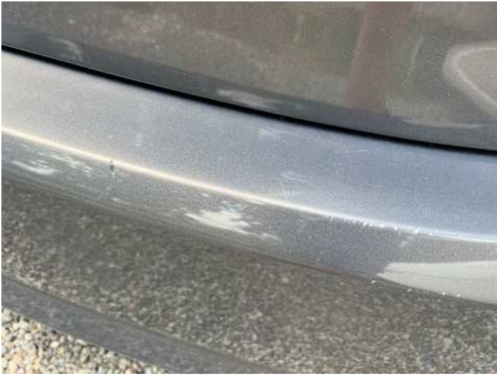
Stoßstange hinten (Lackschaden, Kratzer)
