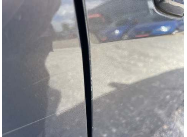
Beifahrtür (Delle, Lackschaden)
