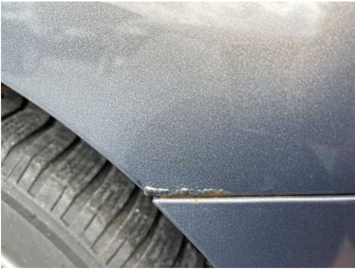
Seitenteil hinten links (Rost)
