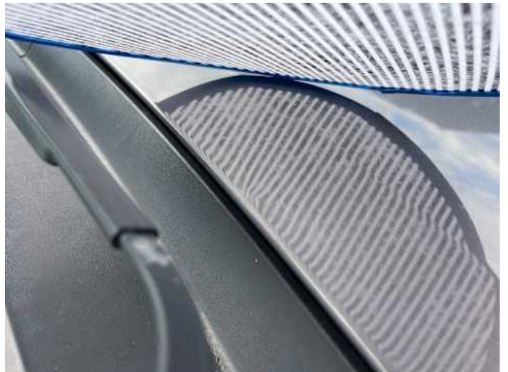
Motorhaube (Delle, Lackschaden)
