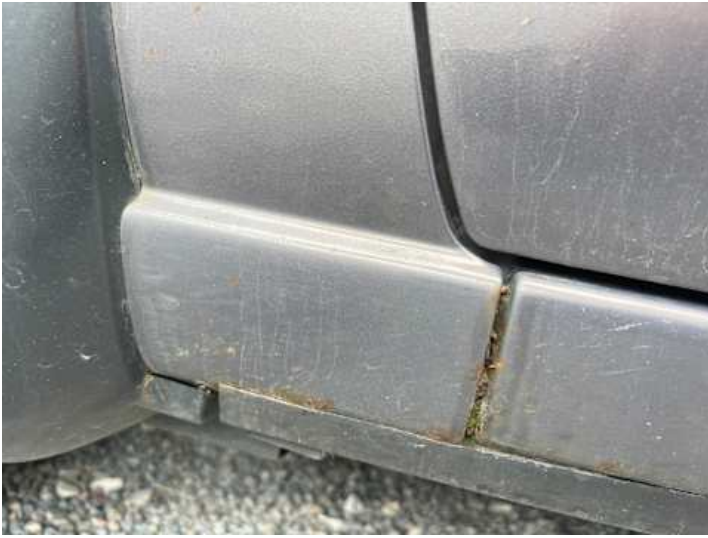
Kotflügel vorne links (Rost)
