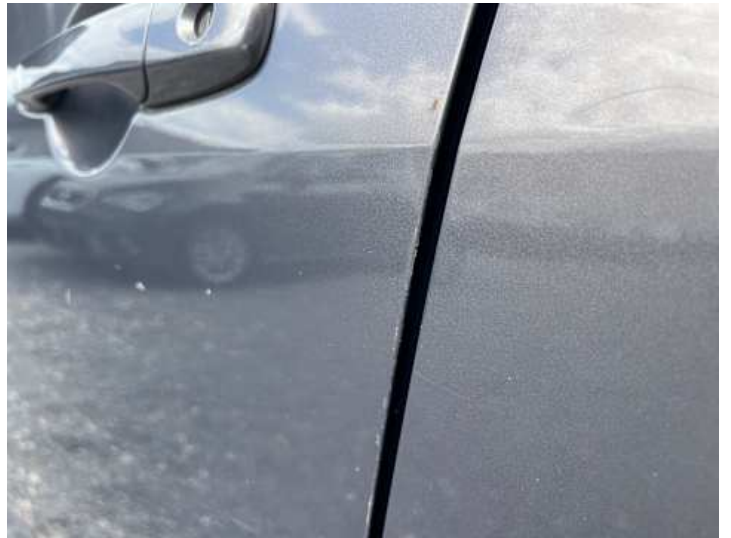
Fahrtür (Lackschaden, Kratzer)
