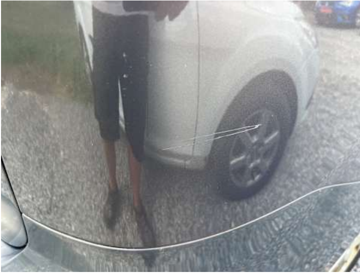
Seitenteil hinten rechts (Lackschaden, Kratzer)
