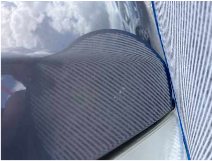
Motorhaube (Delle, Lackschaden)
