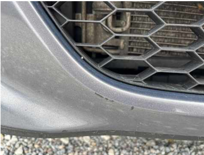
Stoßstange vorne (Lackschaden, Kratzer)
