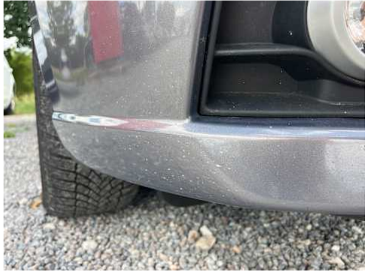
Stoßstange vorne (Lackschaden, Steinschlag)
