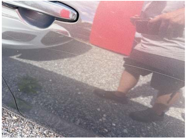
Beifahrtür (Lackschaden, Kratzer)
