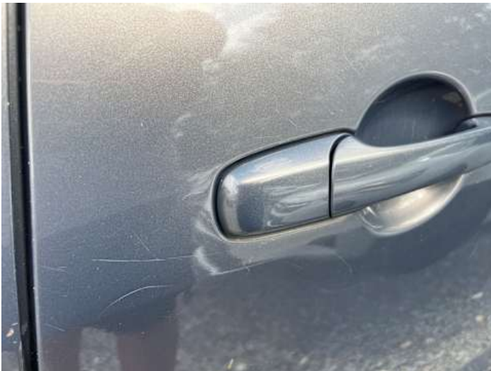
Türe hinten links (Lackschaden, Kratzer)
