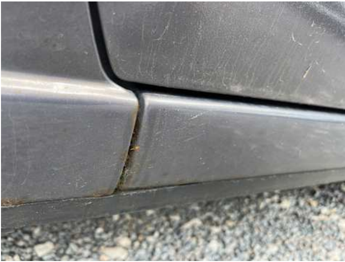
Schweller links (Rost)
