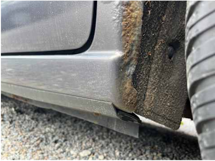
Schweller links (Rost)
