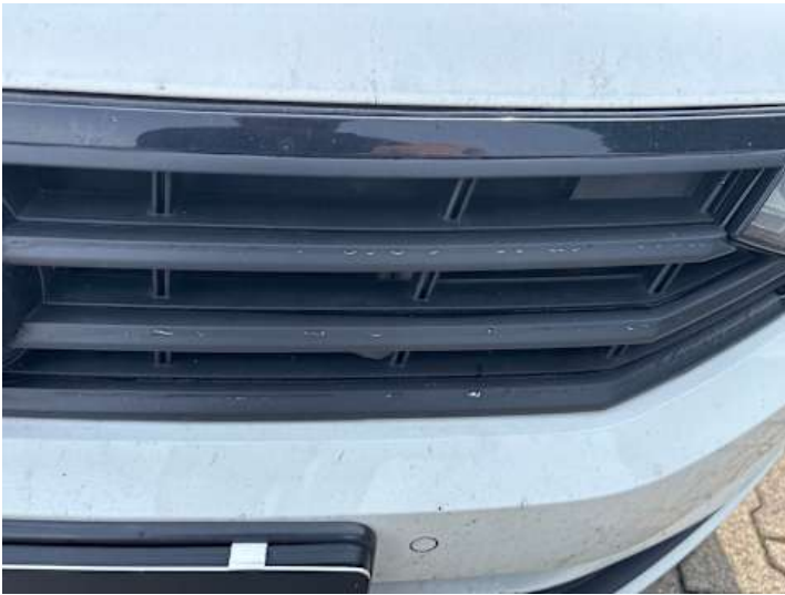
Stoßstange vorne (Anderer Schaden): Folie rissig
