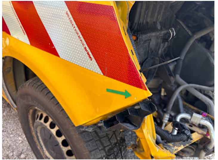
Kotflügel vorne rechts (Verformung)
