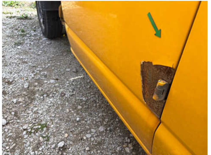
Türe hinten rechts (Lackschaden, Rost)
