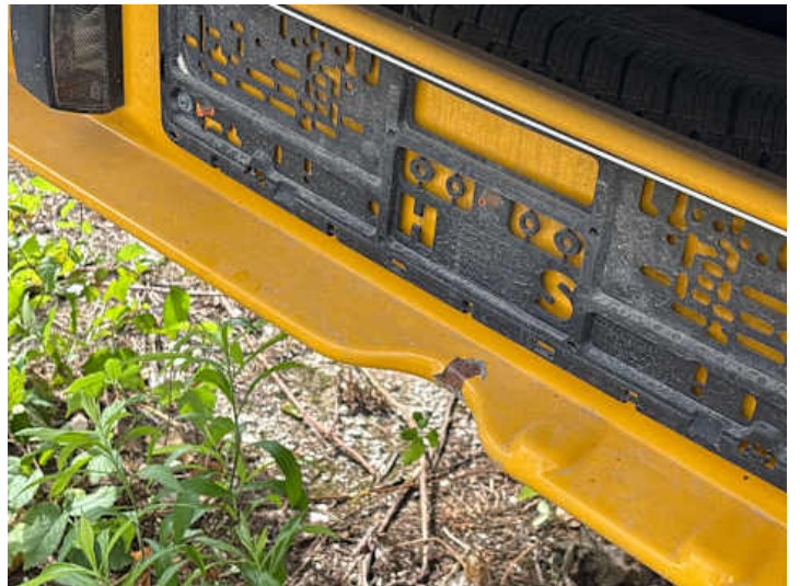
Stoßstange hinten (Lackschaden)
