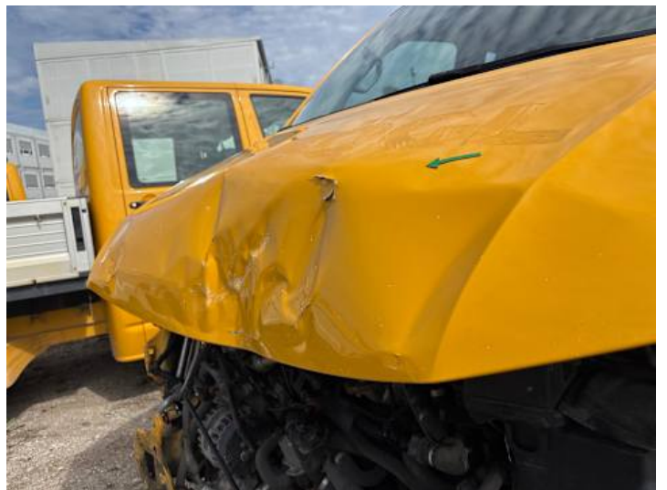
Motorhaube (Verformung, Kratzer)
