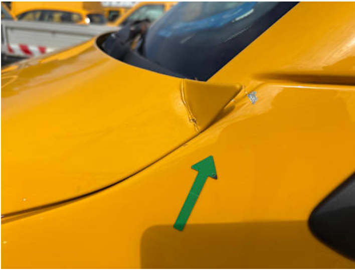
Kotflügel vorne links (Kratzer, Spaltmaße ungenau)
