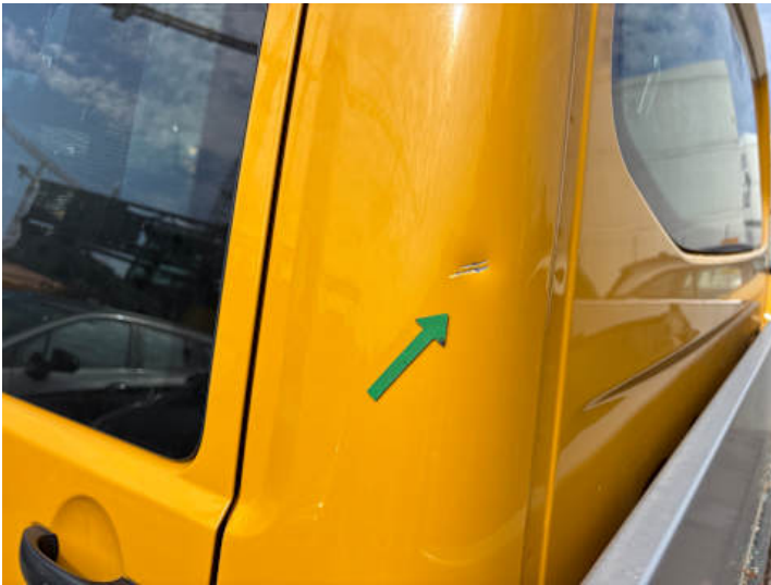
Seitenteil hinten links (Kratzer, Delle)
