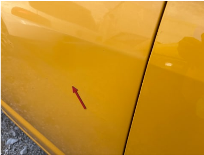
Türe hinten rechts (Lackschaden, Unsachgemäß instand gesetzt)
