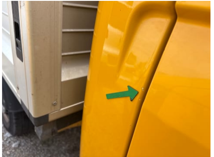
Seitenteil hinten rechts (Kratzer)
