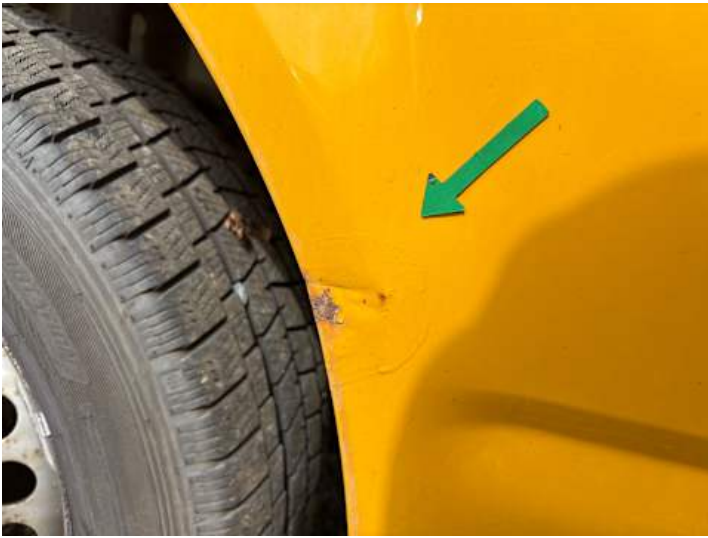
Fahrertür (Kratzer, Lackschaden, Unsachgemäß instand gesetzt)
