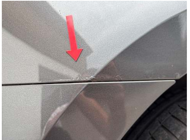
Seitenteil hinten rechts (Rost)
