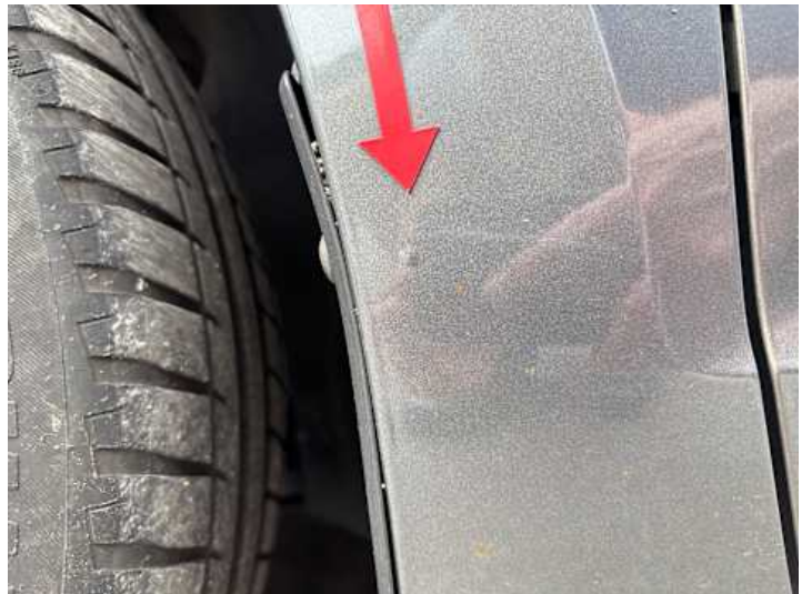
Kotflügel vorne links (Rost)
