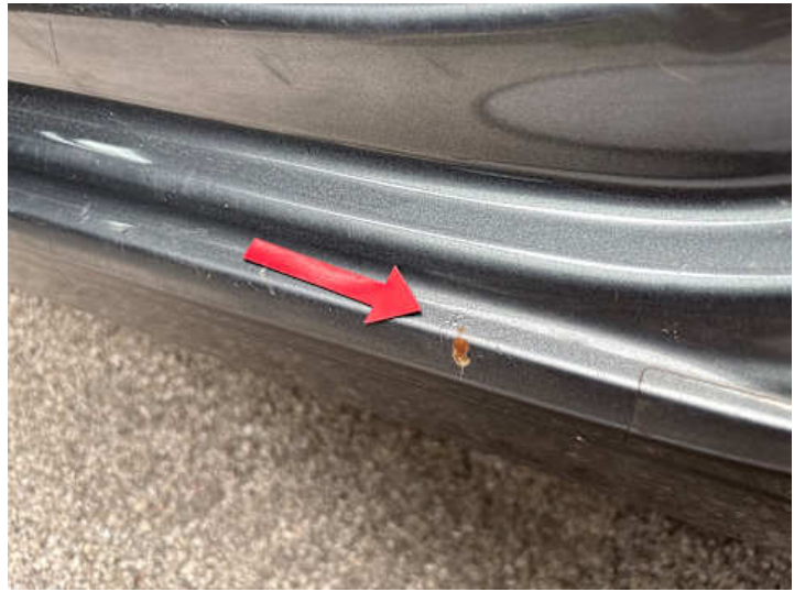
Schweller links (Rost)
