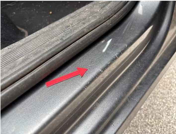
Schweller rechts (Rost)
