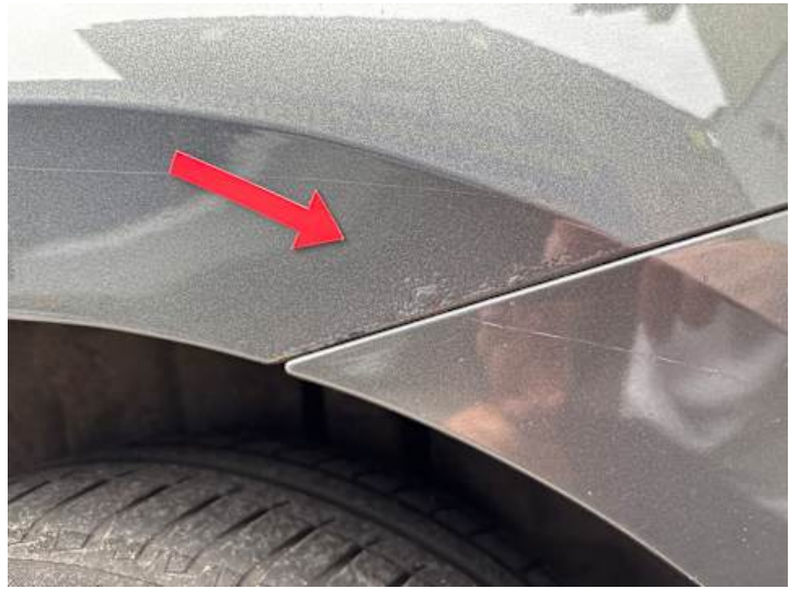
Seitenteil hinten links (Rost)
