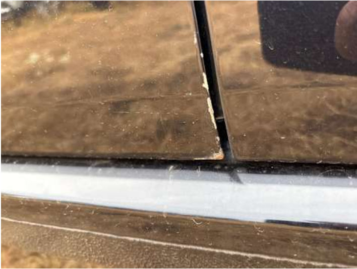
Fahrtür (Kratzer, Rost)
