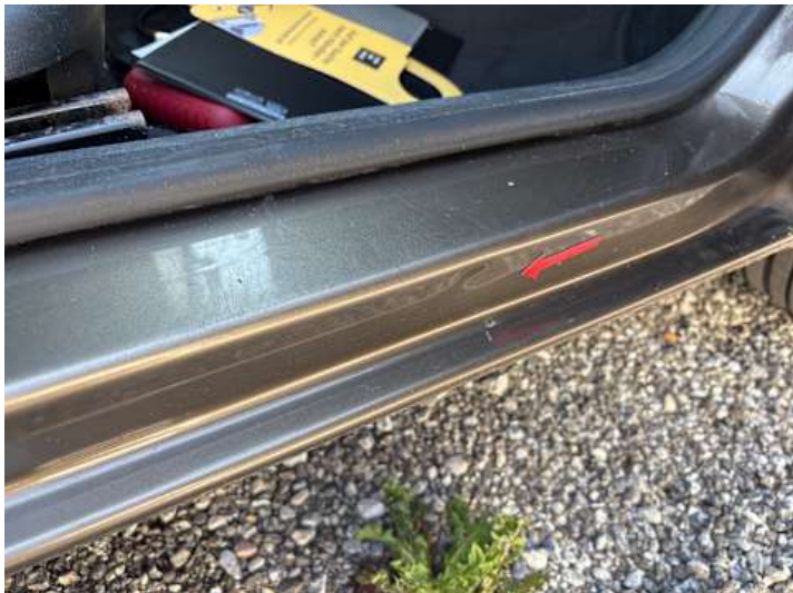
Schweller rechts (Kratzer, Delle)
