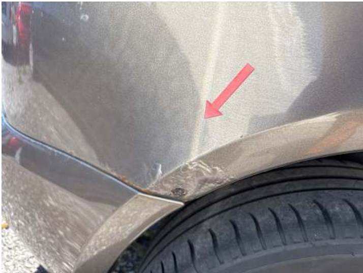
Seitenteil hinten rechts (Rost)
