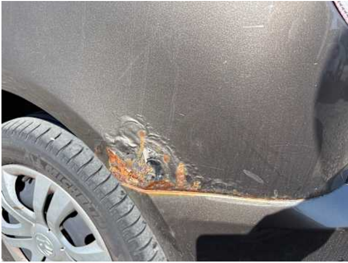
Seitenteil hinten links (Rost)
