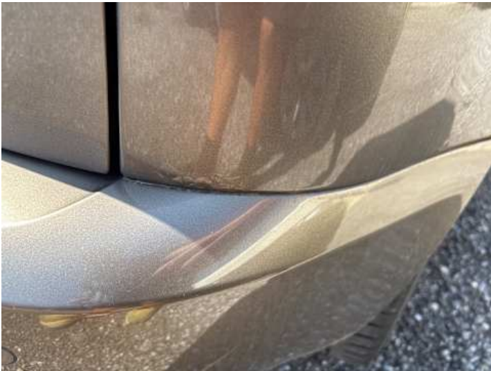
Seitenteil hinten rechts (Rost)
