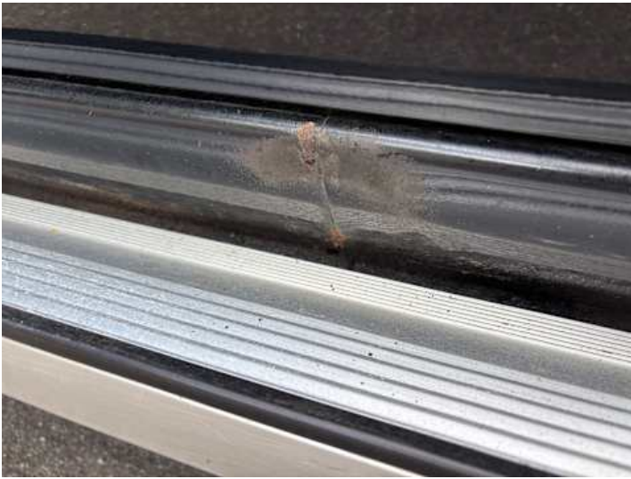
Schweller links (Rost)
