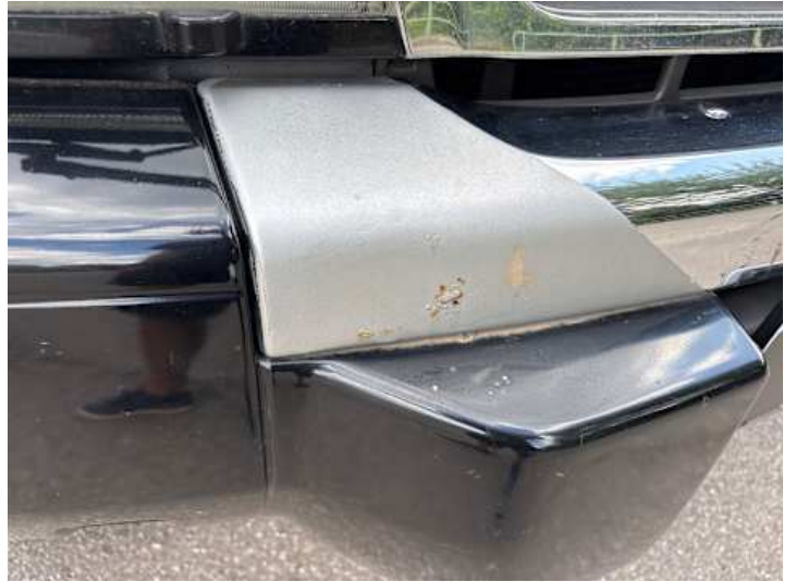
Stoßstange vorne (Lackschaden, Rost, Kratzer)
