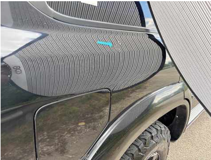
Seitenteil hinten rechts (Rost, Delle)
