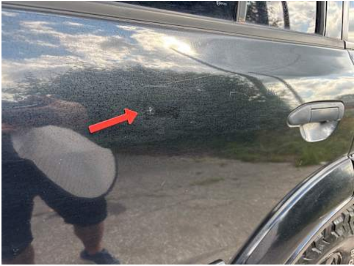
Türe hinten links (Rost)
