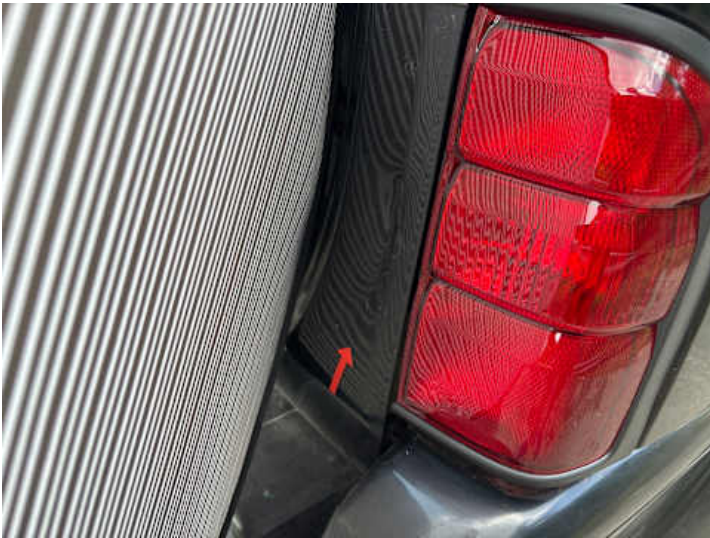
Heckklappe (Delle, Verformung, Rost)
