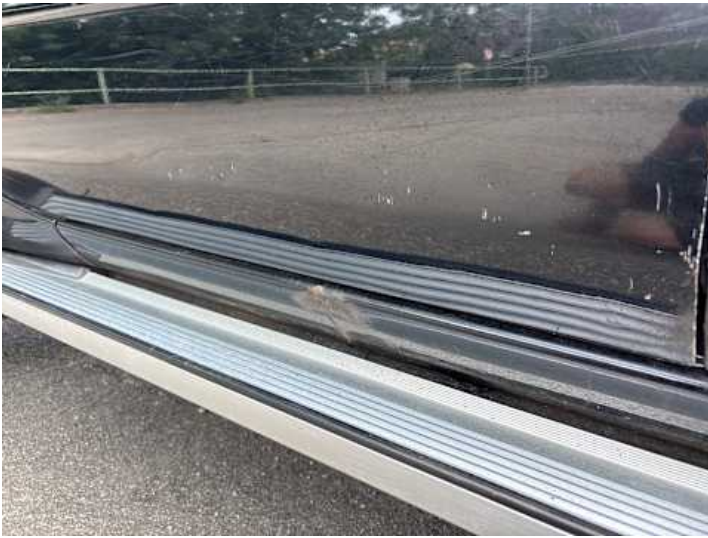
Fahrertür (Delle, Kratzer, Lackschaden)
