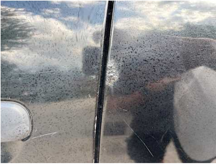
Türe hinten links (Rost)
