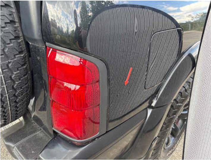
Seitenteil hinten rechts (Rost, Delle)
