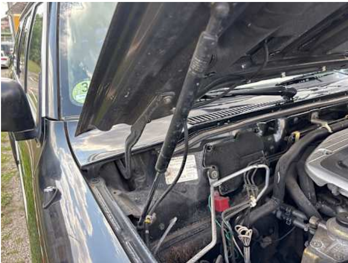
Motorhaube (Anderer Schaden): Dämpfer ohne Funktion
