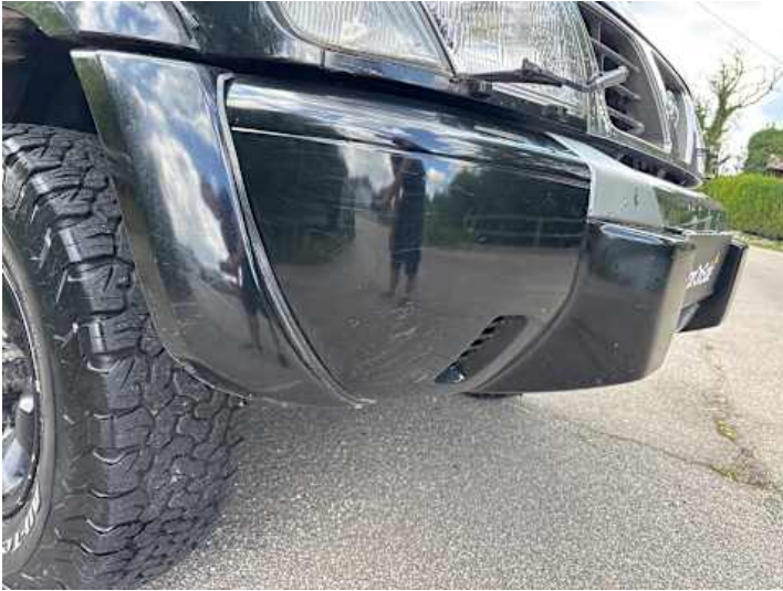
Stoßstange vorne (Lackschaden, Rost, Kratzer)
