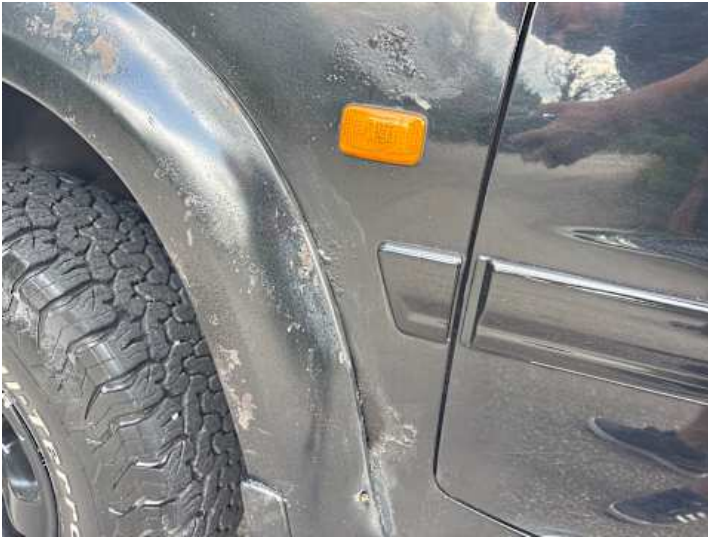
Kotflügel vorne links (Rost, Lackschaden, Unsachgemäß instand gesetzt)
