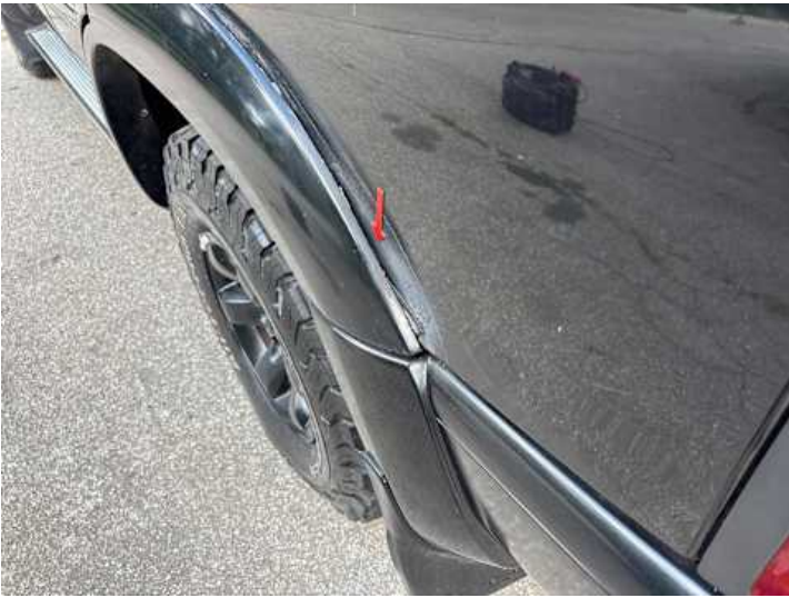
Seitenteil hinten links (Rost, Unsachgemäß instand gesetzt, Lackschaden)
