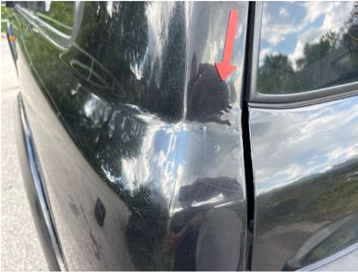
Seitenteil hinten links (Rost, Unsachgemäß instand gesetzt, Lackschaden)
