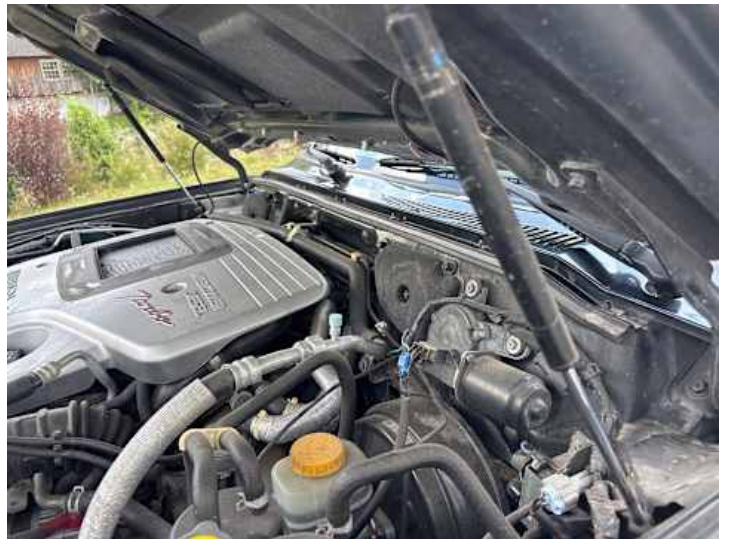
Motorhaube (Anderer Schaden): Dämpfer ohne Funktion
