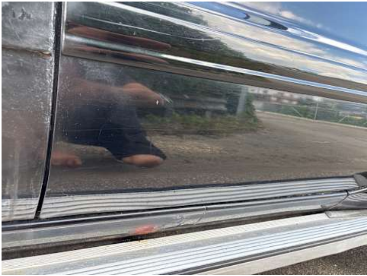
Beifahrertür (Lackschaden, Unsachgemäß instand gesetzt, Kratzer, Delle)
