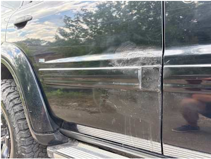
Türe hinten rechts (Unsachgemäß instand gesetzt, Lackschaden, Rost, Kratzer)
