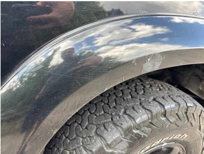
Kotflügel vorne rechts (Lackschaden, Unsachgemäß instand gesetzt, Rost)
