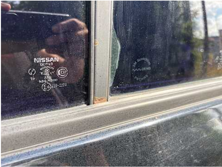
Türe hinten links (Rost)
