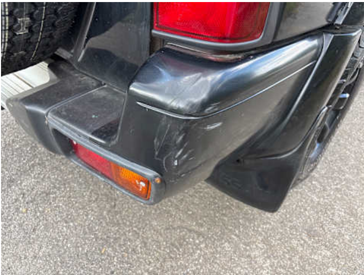
Stoßstange hinten (Unsachgemäß instand gesetzt, Lackschaden, Verformung, Kratzer)
