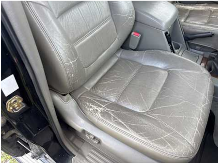
Innenraum (Riss/Bruch, Verschleiß, Verschmutzung)
