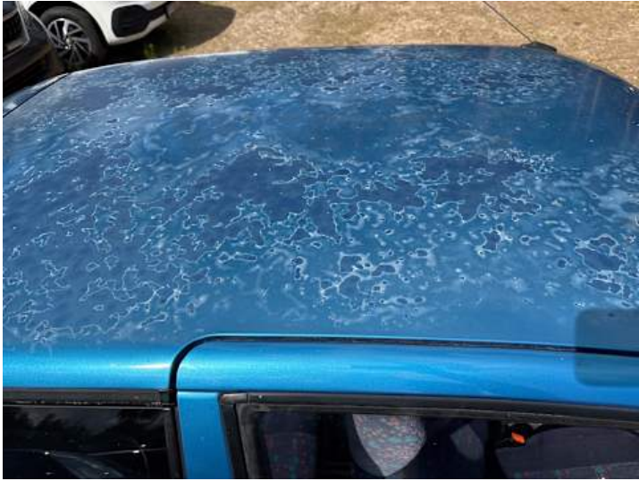
Dach (Delle, Lackschaden)
