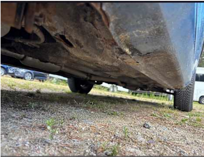
Schweller rechts (Rost)
