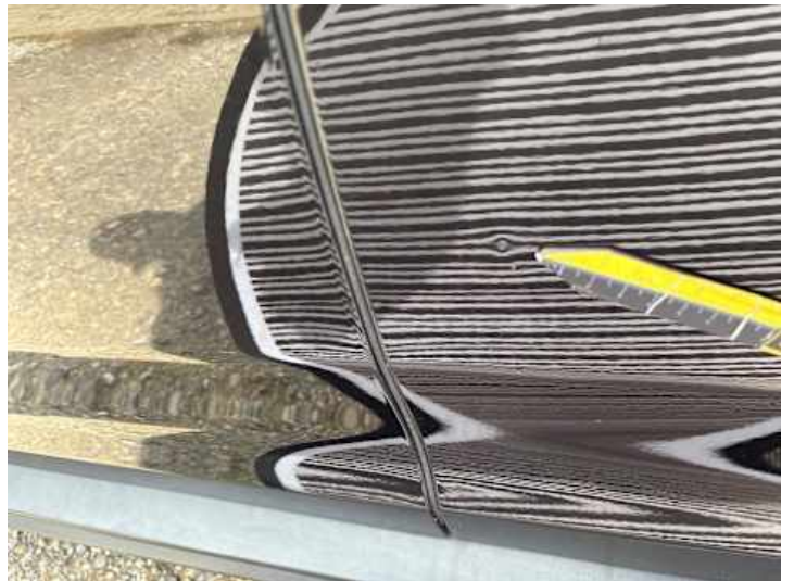
Türe hinten links (Delle, Steinschlag)
