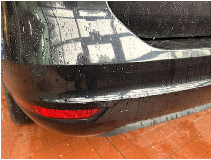
Stoßstange hinten (Spaltmaße ungenau, Verformung, Kratzer)
