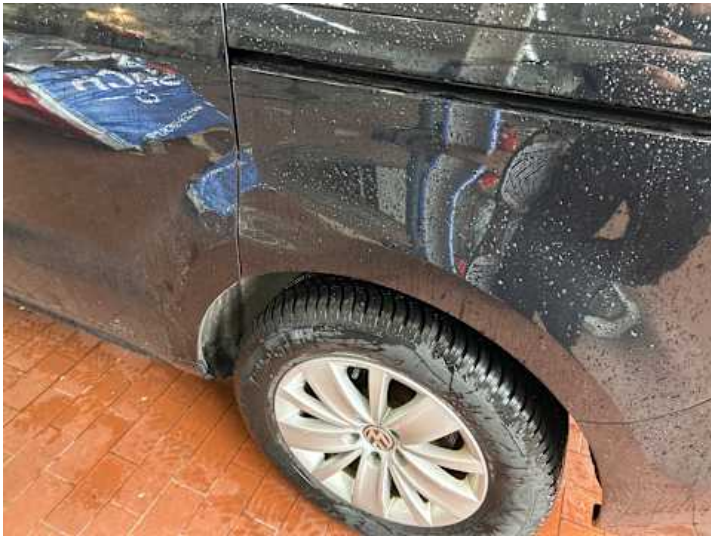
Seitenteil hinten links (Verformung, Kratzer)
