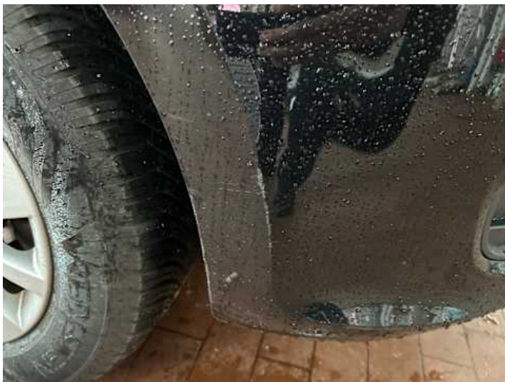
Stoßstange vorne (Verformung, Lackschaden)
