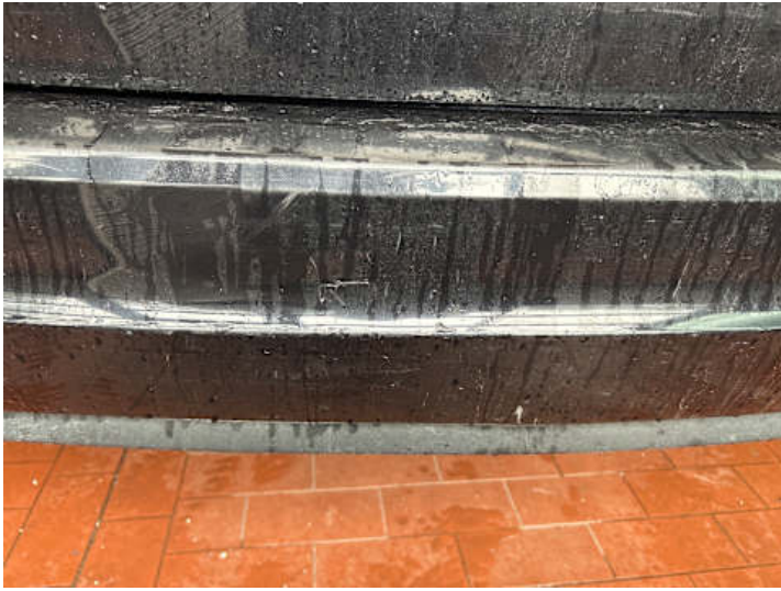
Stoßstange hinten (Spaltmaße ungenau, Verformung, Kratzer)
