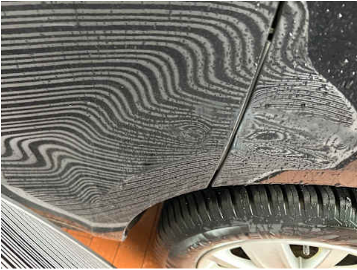
Türe hinten links (Delle, Kratzer)
