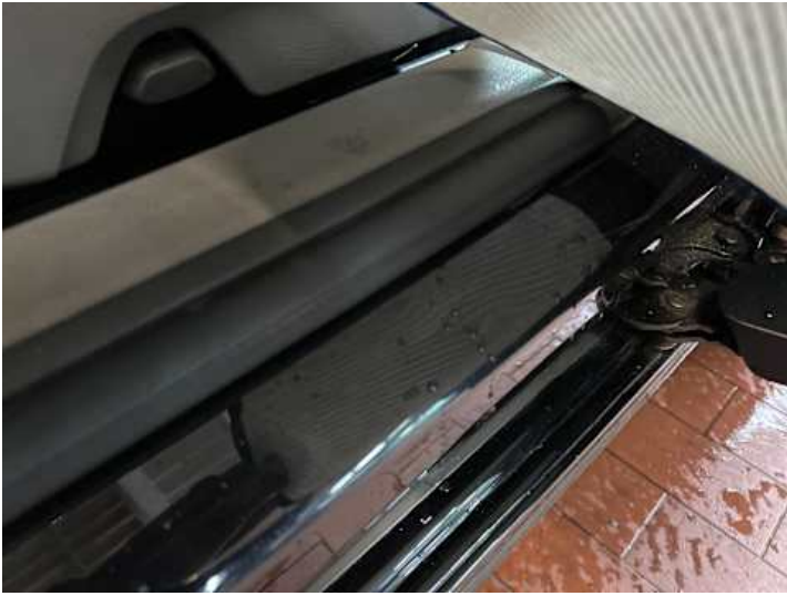
Schweller links (Delle, Kratzer)
