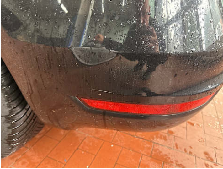
Stoßstange hinten (Spaltmaße ungenau, Verformung, Kratzer)
