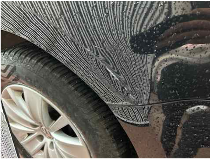
Kotflügel vorne rechts (Lackschaden, Verformung)
