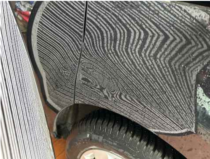
Seitenteil hinten links (Verformung, Kratzer)
