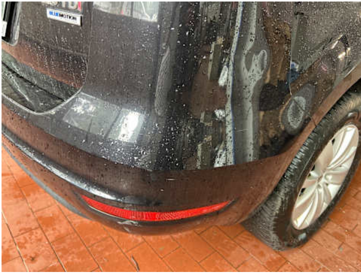
Stoßstange hinten (Spaltmaße ungenau, Verformung, Kratzer)
