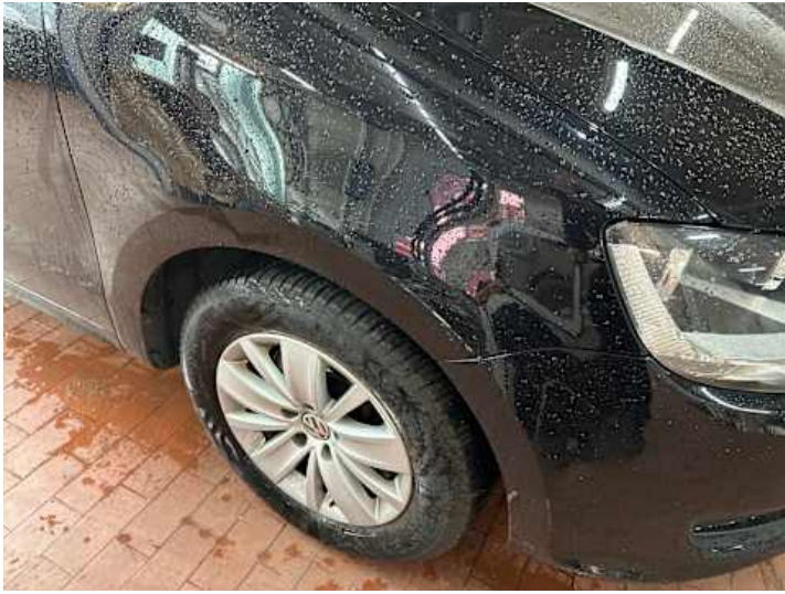
Kotflügel vorne rechts (Lackschaden, Verformung)
