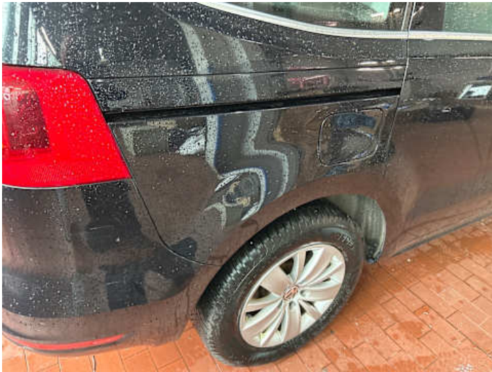
Seitenteil hinten rechts (Kratzer, Delle)
