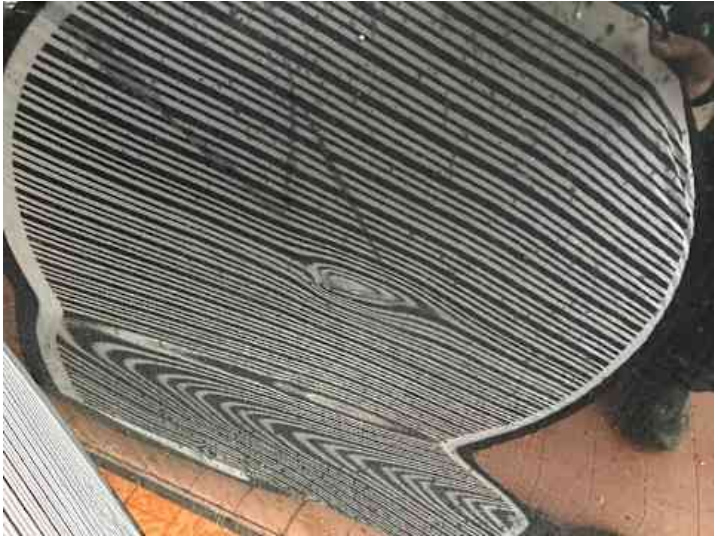
Türe hinten links (Delle, Kratzer)
