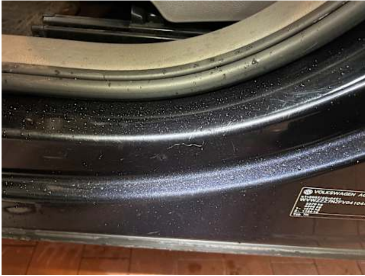
Schweller links (Delle, Kratzer)
