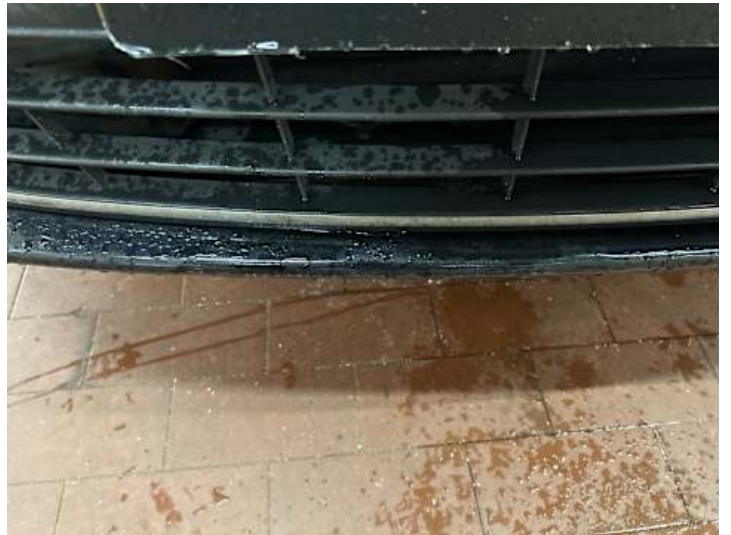
Stoßstange vorne (Verformung, Lackschaden)
