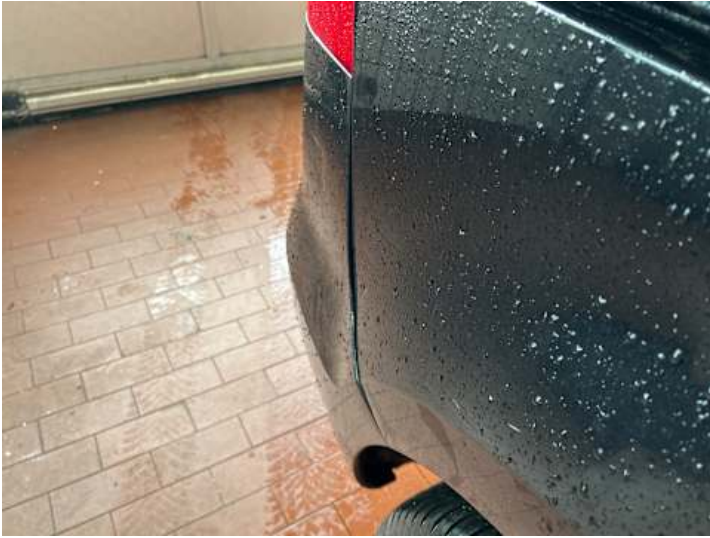
Stoßstange hinten (Spaltmaße ungenau, Verformung, Kratzer)
