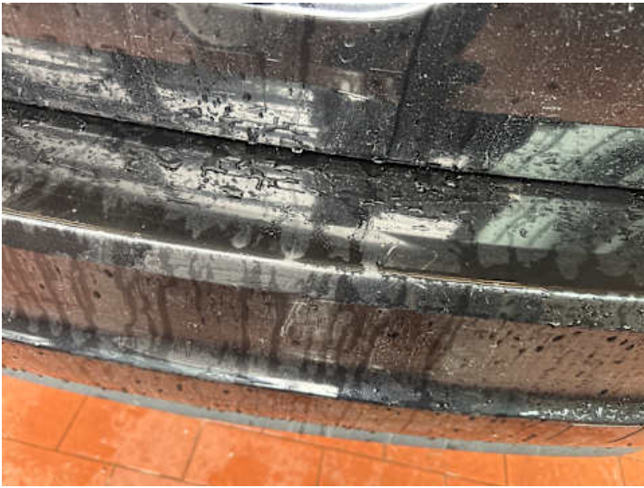
Stoßstange hinten (Spaltmaße ungenau, Verformung, Kratzer)
