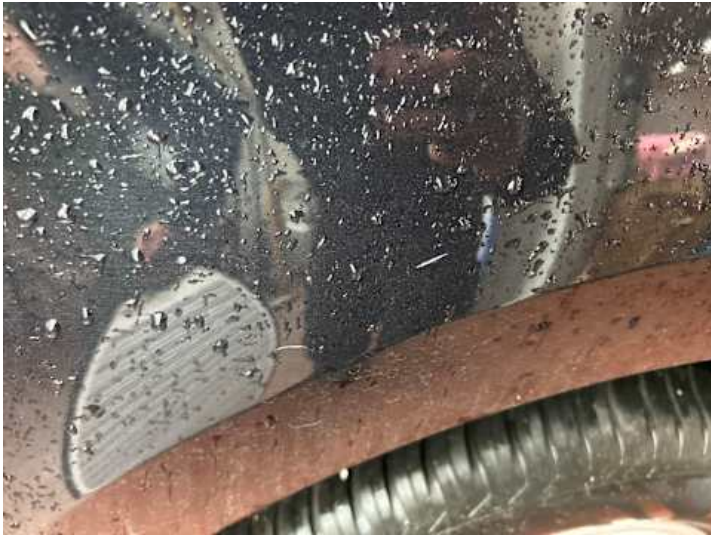
Seitenteil hinten rechts (Kratzer, Delle)
