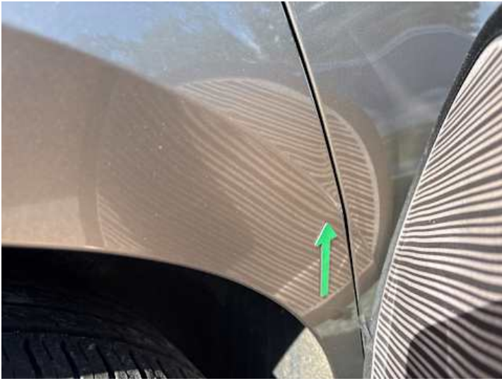
Seitenteil hinten rechts (Kratzer, Lackschaden, Verformung)
