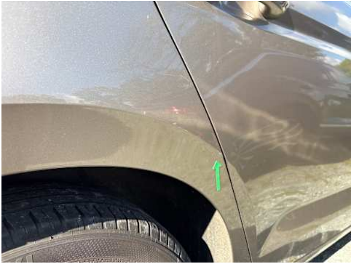
Seitenteil hinten rechts (Kratzer, Lackschaden, Verformung)
