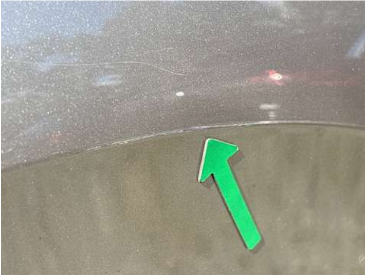
Seitenteil hinten rechts (Kratzer, Lackschaden, Verformung)
