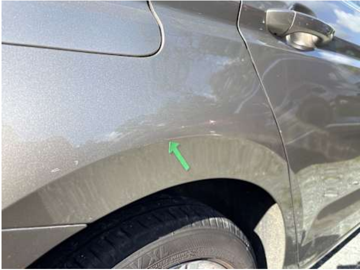
Seitenteil hinten rechts (Kratzer, Lackschaden, Verformung)
