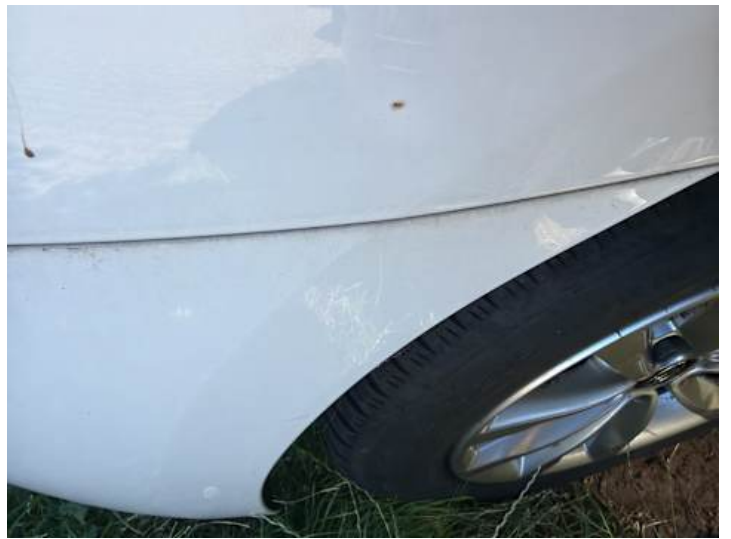
Kotflügel vorne links (Rost, Steinschlag)
