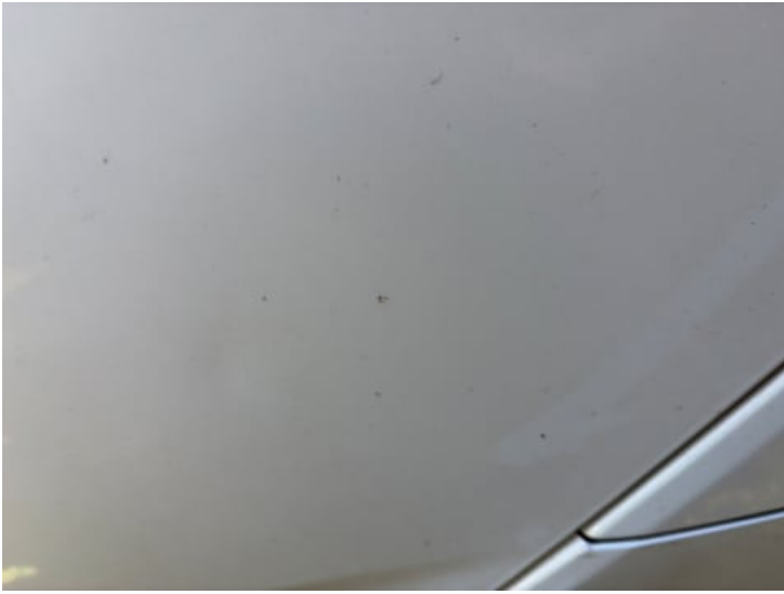
Türe hinten rechts (Steinschlag, Rost)
