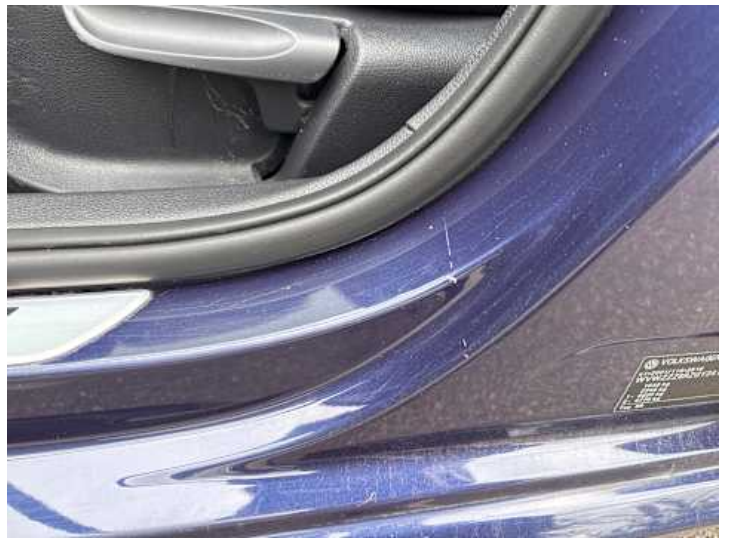
Schweller links (Kratzer)
