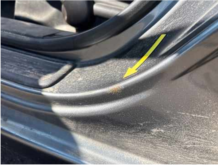
Schweller links (Rost)
