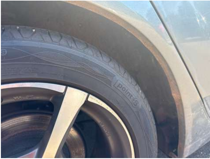
Seitenteil hinten rechts (Rost, Verformung)
