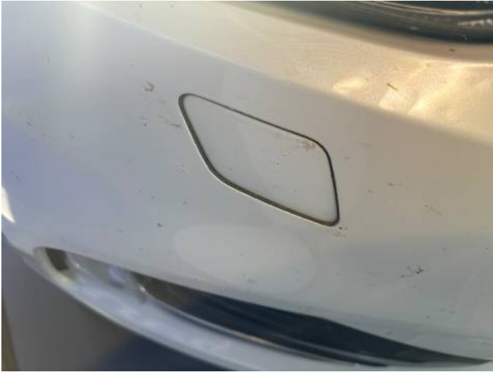
Stoßstange vorne (Spaltmaße ungenau)
