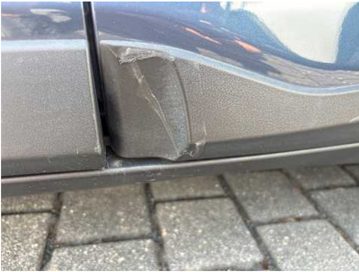
Türe hinten links (Kratzer, Verformung)
