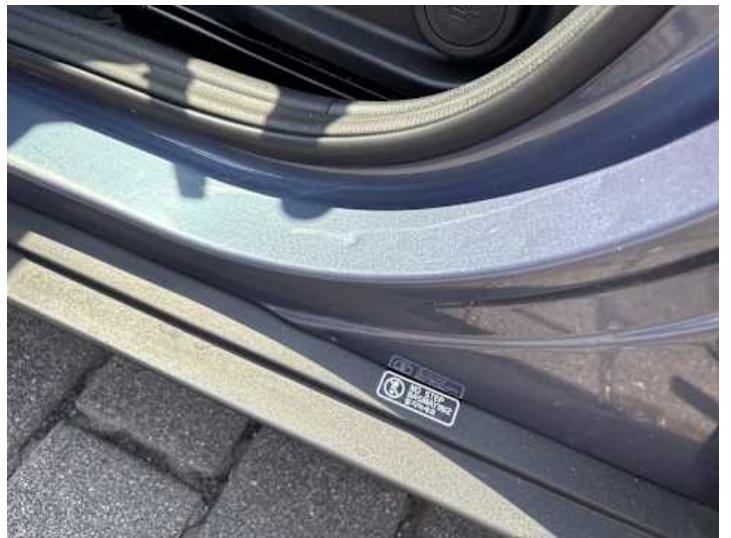
Schweller links (Delle)
