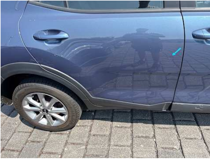
Türe hinten rechts (Delle, Kratzer, Verformung)
