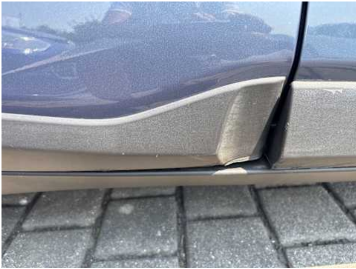
Türe hinten rechts (Delle, Kratzer, Verformung)
