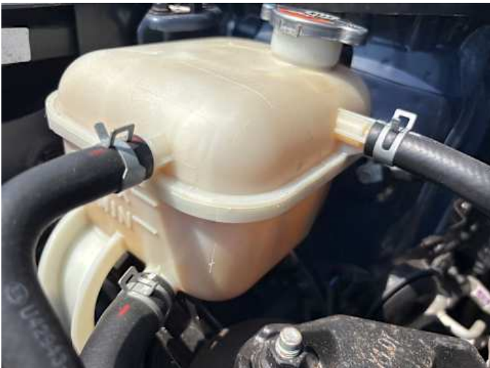
Motorhaube (Anderer Schaden): Kühlmittelstand zu gering,
