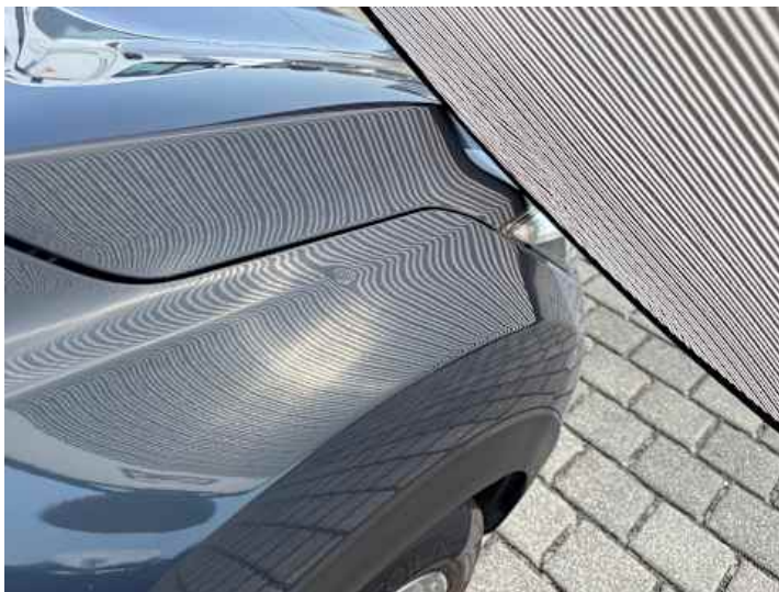
Kotflügel vorne rechts (Delle)
