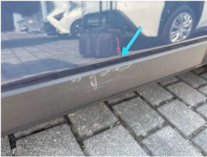
Fahrtür (Kratzer, Verformung)
