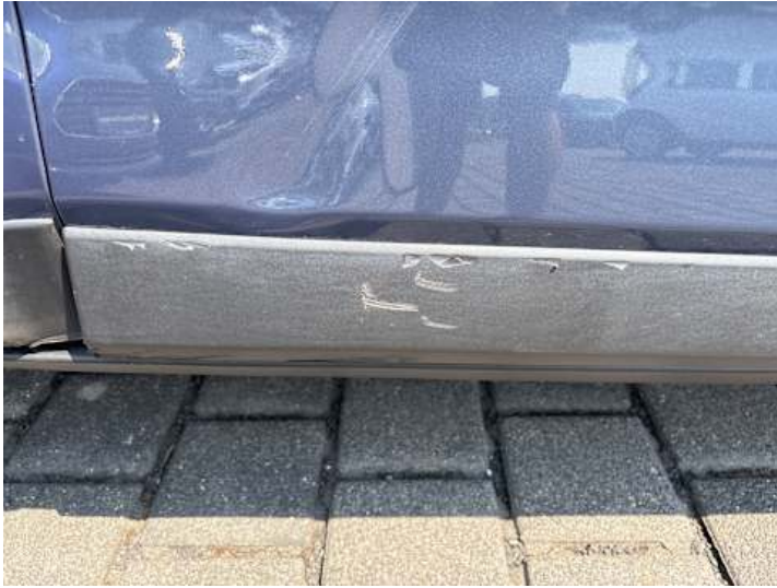
Beifahrtür (Delle, Lackschaden, Kratzer, Verformung)
