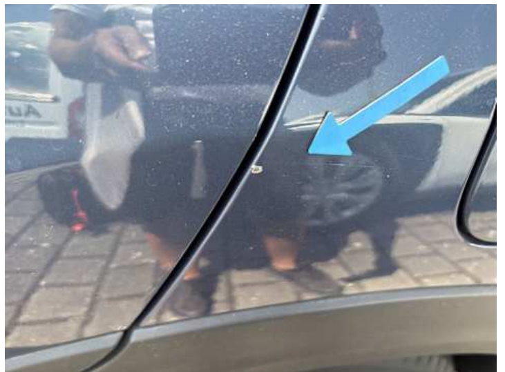
Seitenteil hinten links (Kratzer, Lackschaden)
