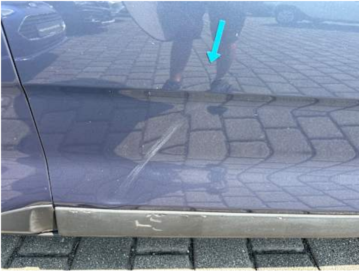
Beifahrtür (Delle, Lackschaden, Kratzer, Verformung)
