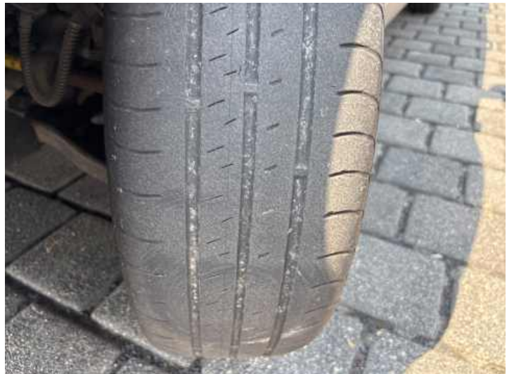
Rad (Ungleichmäßig abgefahren)
