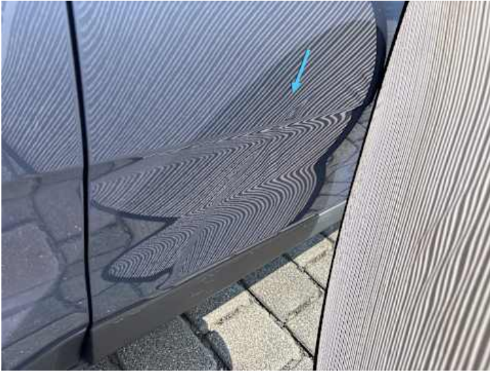
Beifahrtür (Delle, Lackschaden, Kratzer, Verformung)
