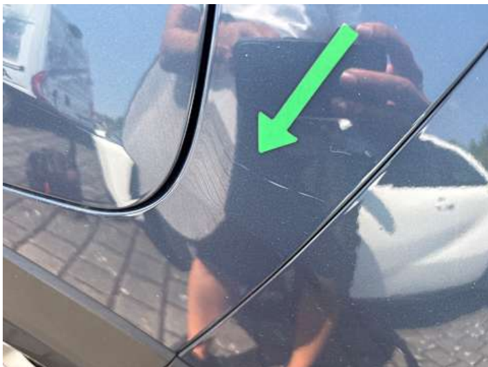
Seitenteil hinten links (Kratzer, Lackschaden)
