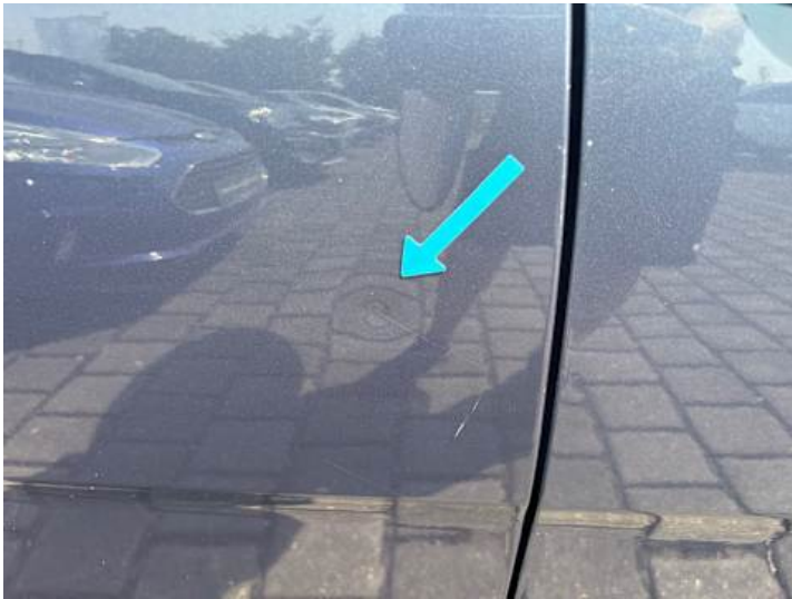
Türe hinten rechts (Delle, Kratzer, Verformung)
