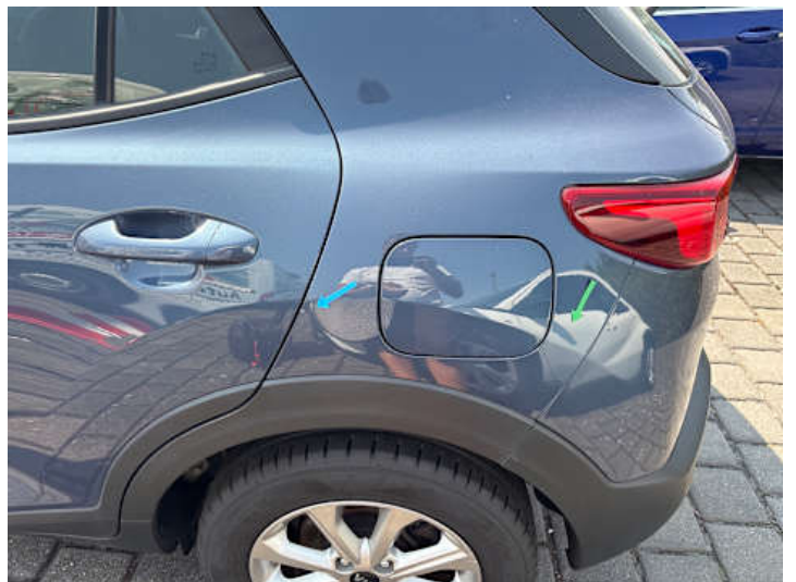
Seitenteil hinten links (Kratzer, Lackschaden)
